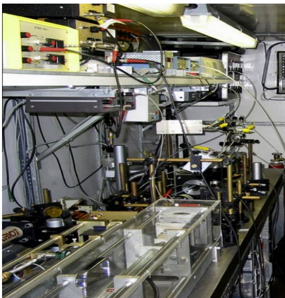
Слика 1.2 Фотографија мобилног ФА система за праћење атмосферских полутаната. Извор: [Sigrist, 2015].
