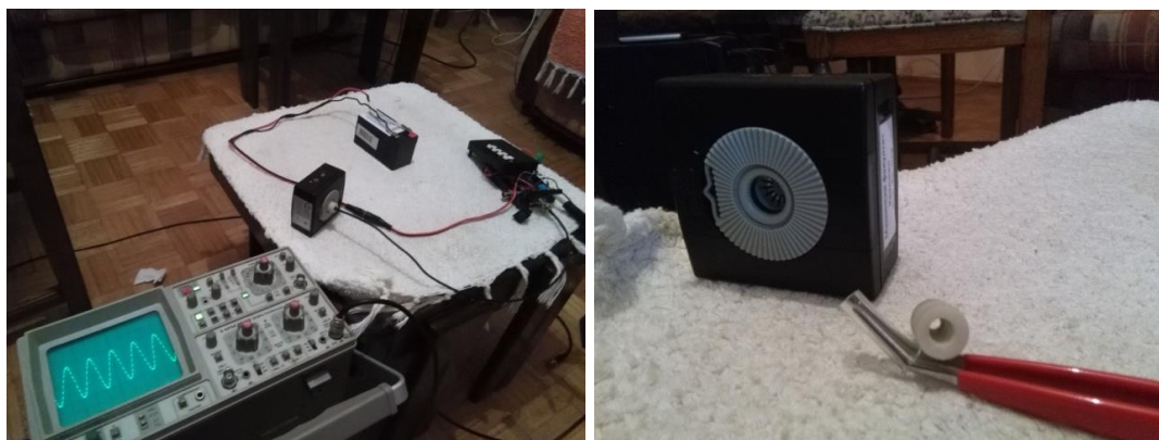
Слика 7.14: Експериментална апаратура за одређивање излазне импедансе и осетљивости микрофона, а) целокупна апаратура и б) калибратор са адаптером.
