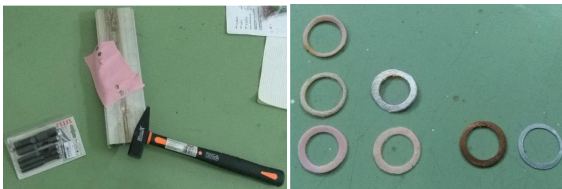
Слика 6.35: а) Алат за припрему O-ring подметача и б) O-ring подметачи од гуме, картона, бакра и алуминијума разврстани по колонама.
