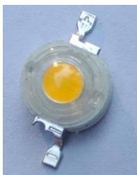
Слика 6.8: LED коришћен у развијеном ФАМС.
