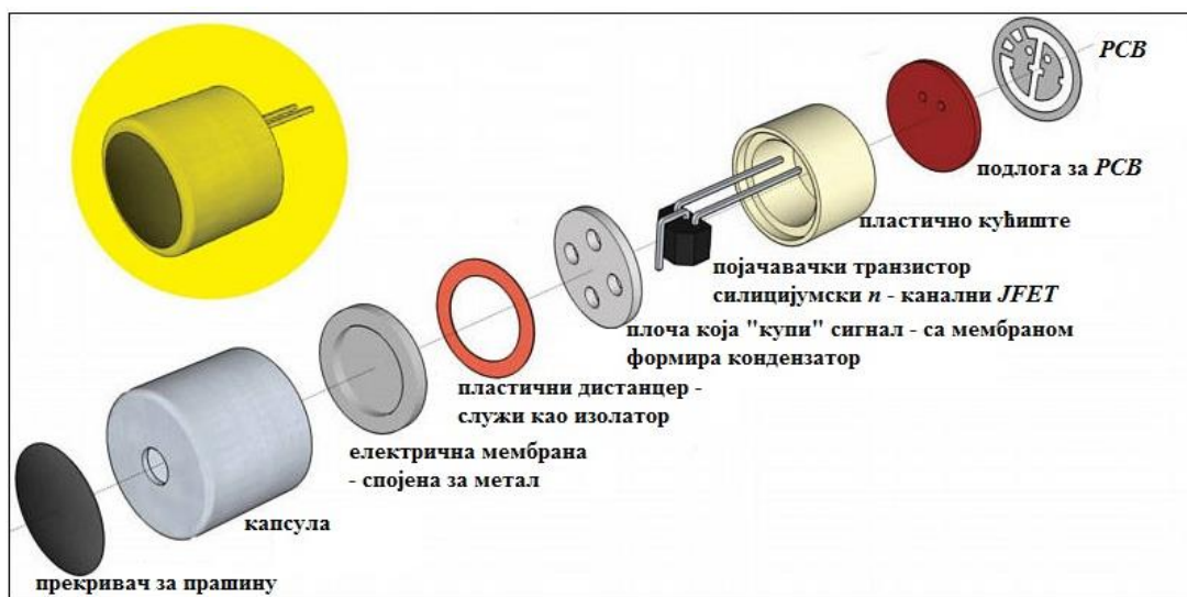
Слика 6.18 (преузето и прерађено са интернет адресе [87]): Саставни делови електретског микрофона.
