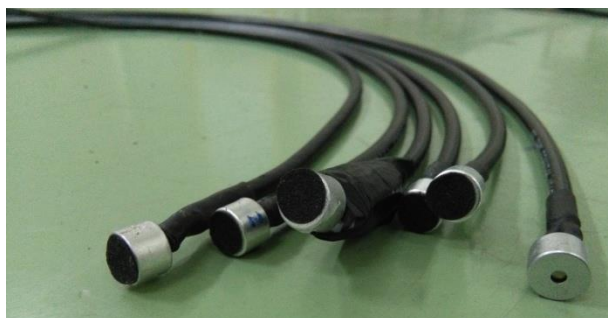
Слика 6.20: Микрофони са залемљеним кабловима спремни за испитивање преносне карактеристике детекционог дела ФАМС.
