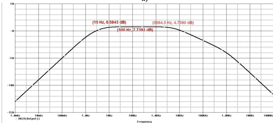
Слика 6.24: Фреквенцијски одзив првог напонског појачавача за а) појачање 69 и б) појачање 101.
