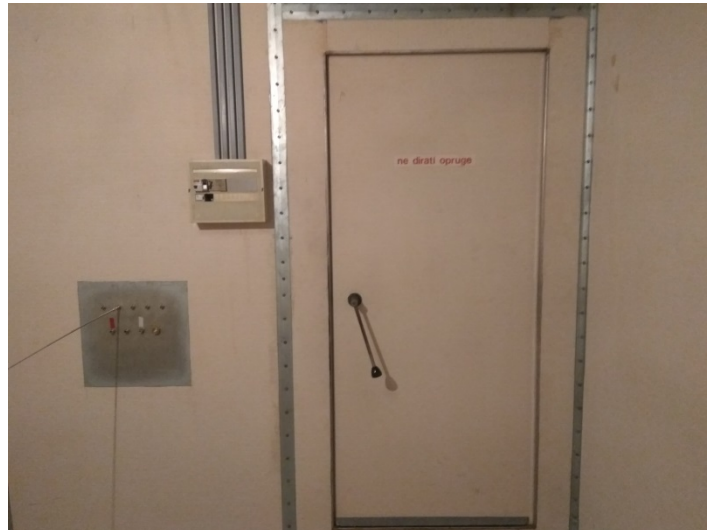
Slika 3.4 Vrata i konektorsko polje Faradejevog kaveza
