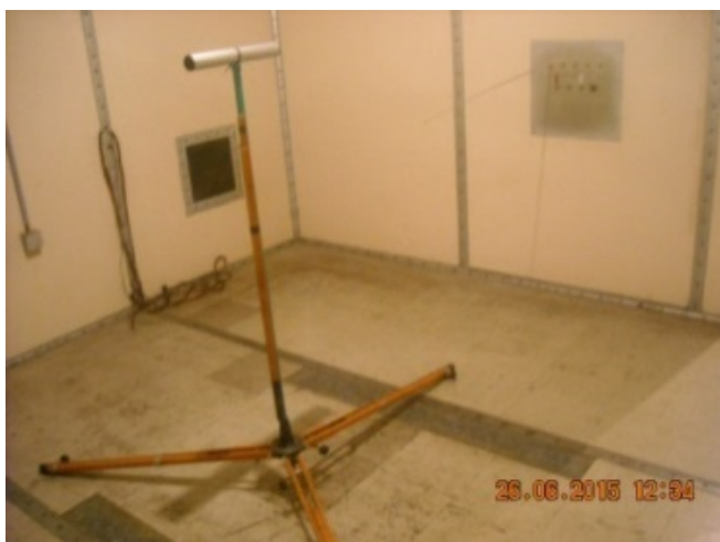
Slika 4.8 Fotografije merne postavke u Faradejevom kavezu
