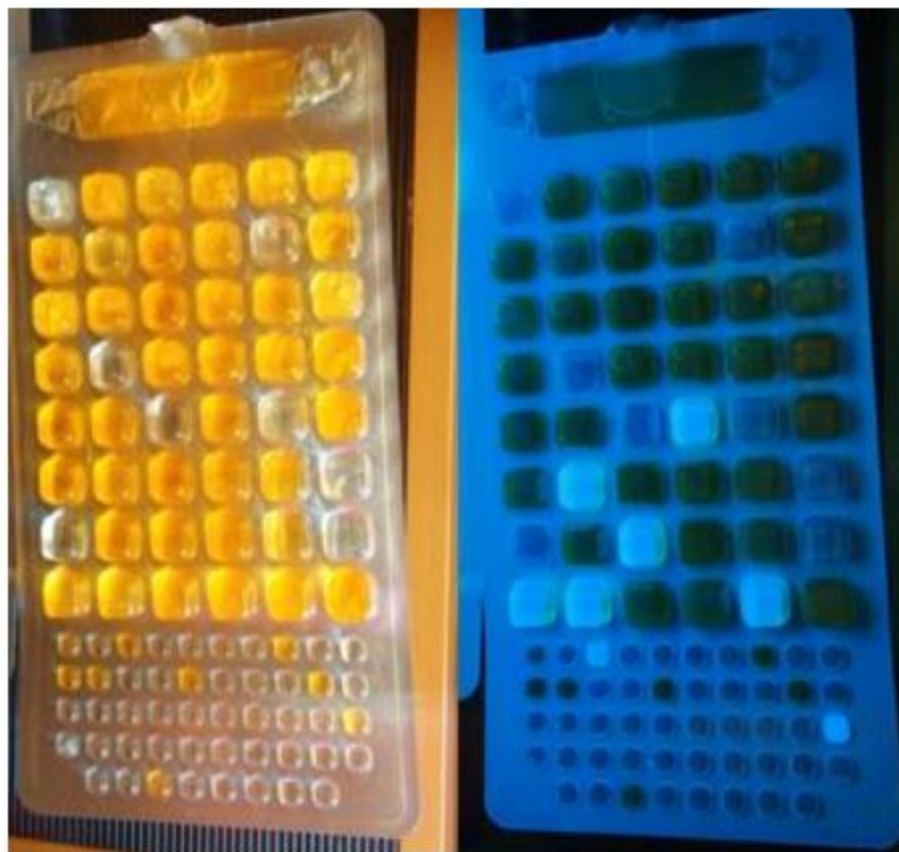
Slika 3.10. Totalni koliformi i E. coli – metod najverovatnijeg broja pomoću Colilert 18 sistema (slika preuzeta iz Kolarević, 2014)
