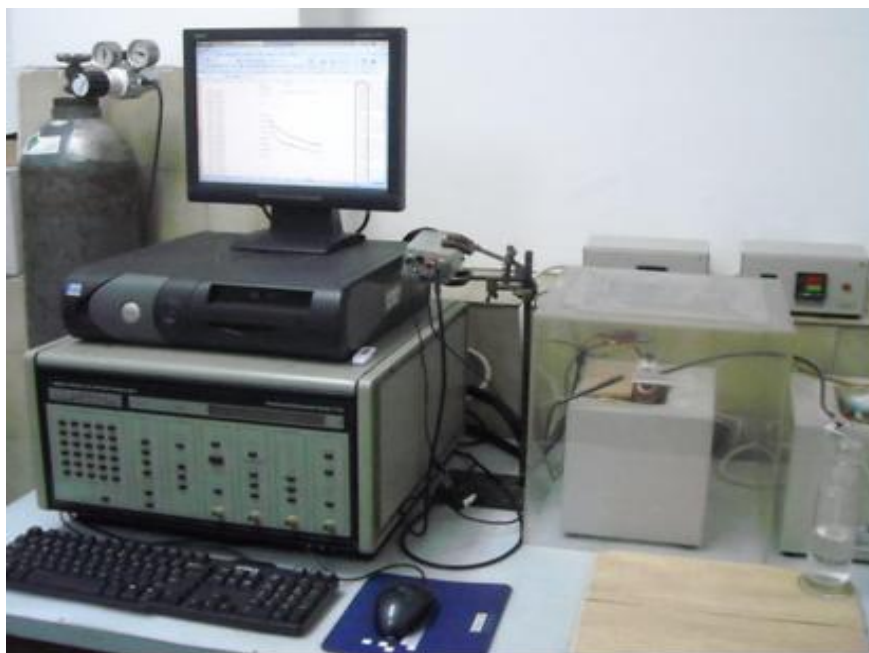
Slika 3.1. Sistem na kome su rađeni elektrohemijski eksperimenti (boca sa argonom, potenciostat 273A sa računarom za kontrolu i peč sa ćelijom).
