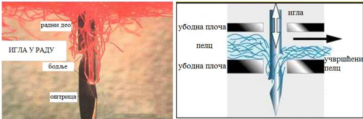
Слика 25 . Процес иглања (лево) и скица (десно) [86]
