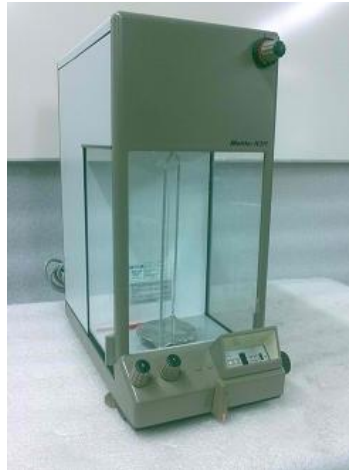
Слика 45. Аналитичка вага Mettler Н311 [109]
