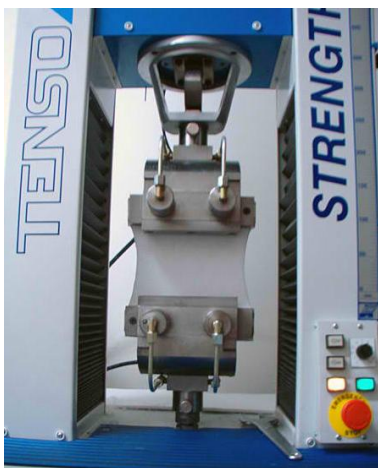
Слика 47. Динамометар произвођача Mesdan - испитивање прекидне силе геотекстила према SRPS EN ISO 10319:2012 [113]
