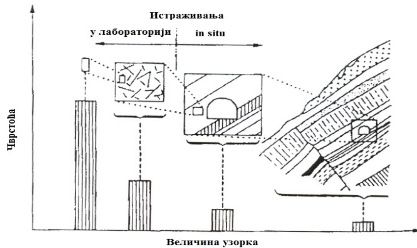
Слика 2.4. Зависност чврстоће стијенске масе од величине разматраног подручја (по Janelid-у , 1965). За случај једне просторије, критична површина оптерећења је мала, чврстоћа стијенске масе је велика. За случај тунела већа расподела напона око подземне просторије утиче на већу оптерећену површину услед већих појава ослабења а мању чврстоћу стијенску масу [32].
