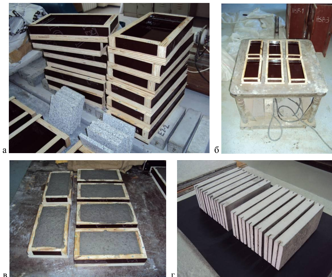
Слика 90 Припрема узорка: а) формирање калупа, б) припрема за уградњу малтера на вибро-столу, в) уграђени узорци, г) готови узорци
