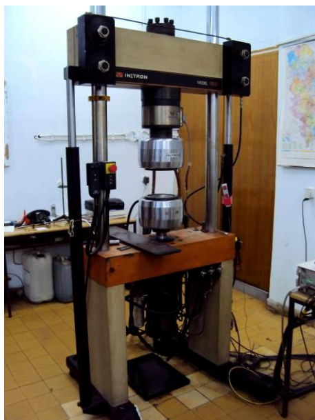
Слика 88 Испитивање чврстоће при савијању композитног фасадног панела: а) испитна композиција, б) испитна опрема, в) лом – појава пукотине на половини распона панела
