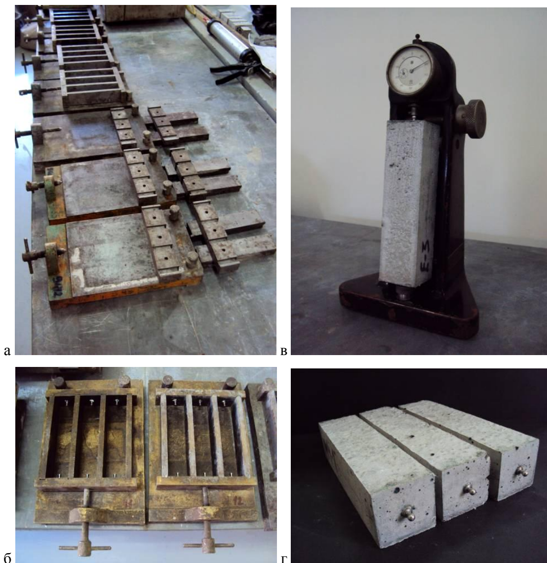
Слика 70 Припрема узорака и испитивање скупљања: а) припрема калупа, б) припремљени калупи са уграђеним реперима, в) испитивање скупљања уз помоћ компаратора, г) серија испитних узорака
