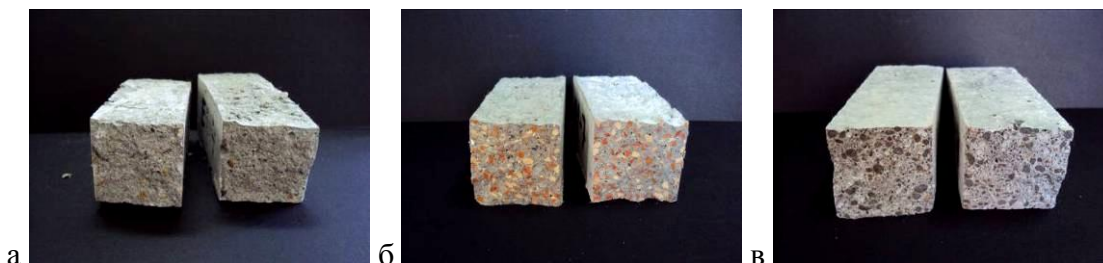
Слика 59 Површина лома: а) узорак са речним песком E_1 , б) узорак са речним песком и дробљеном опеком M_1 , в) узорак са експандираном глином M_3
