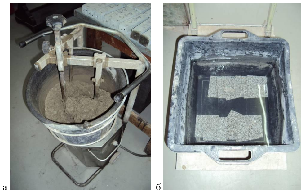
Слика 74 Припрема компонентних материјала узорака:
