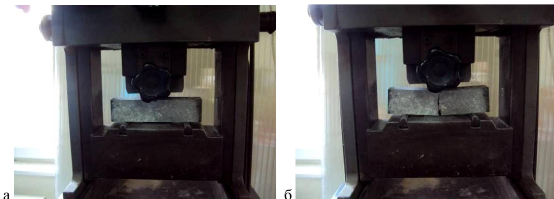
Слика 55 Испитивање чврстоће при савијању призматичних узорака: а) пре наношења оптерећења, б) након лома
