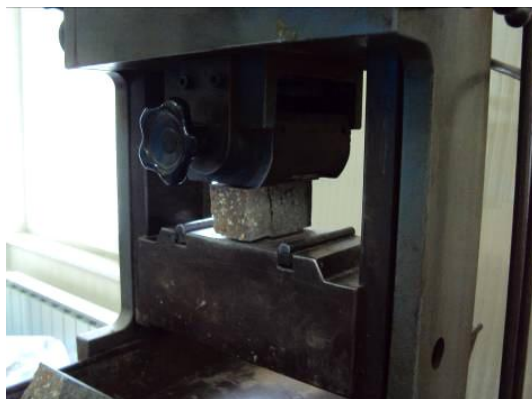
Слика 60 Испитивање чврстоће при притиску на полуткама призматичних узорака
