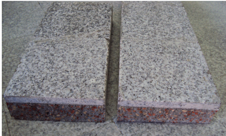
Слика 89 Површина лома узорка
