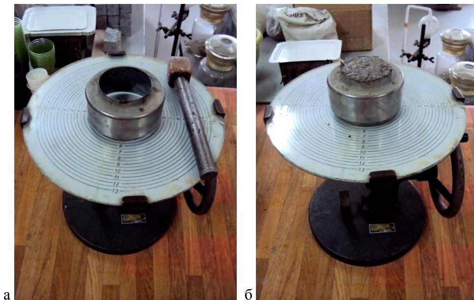
Слика 48 Испитивање конзистенције методом распростирања:
