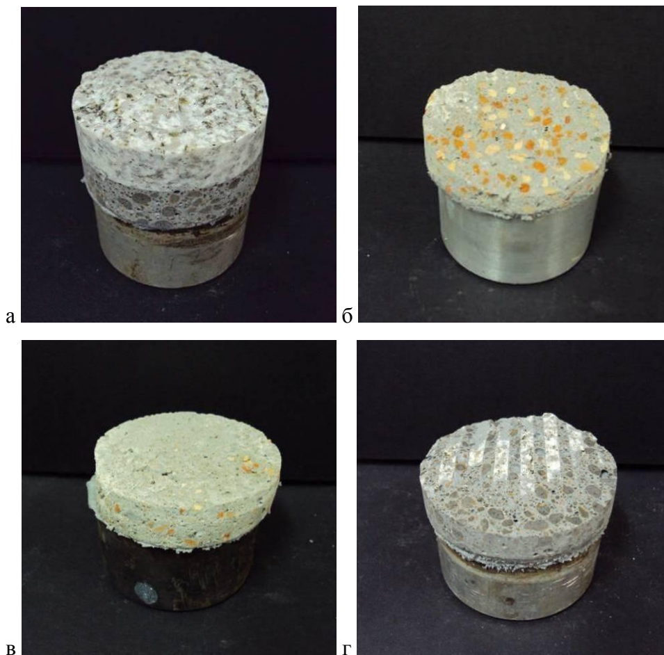
Слика 84 Остварени лом узорака: а) кохезиони лом преко камена, б) кохезиони лом преко малтера, в) адхезиони лом, г) мешовити лом
