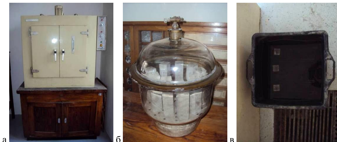
Слика 64 Испитивње упијања воде:
