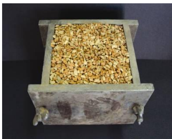
Слика 40 Дробљена опека употребљена у експерименталном истраживању: фракција 2/4 mm
