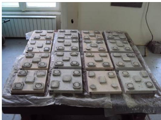
Слика 76 Све серије узорка припремљене за испитивање приањања малтера за подлогу од камена
