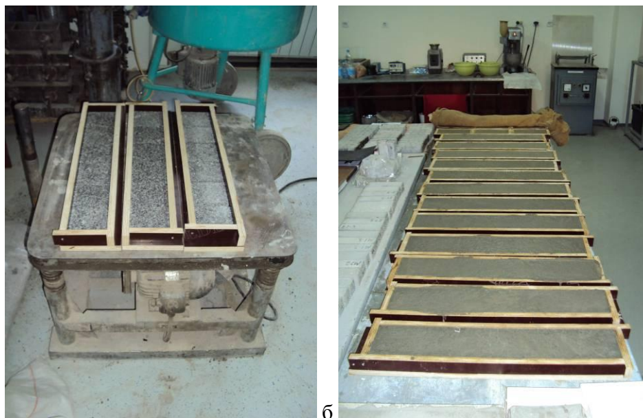
Слика 85 Припрема узорака: а) калупи са каменим плочицама на вибро-столу, б) уграђени узорци
