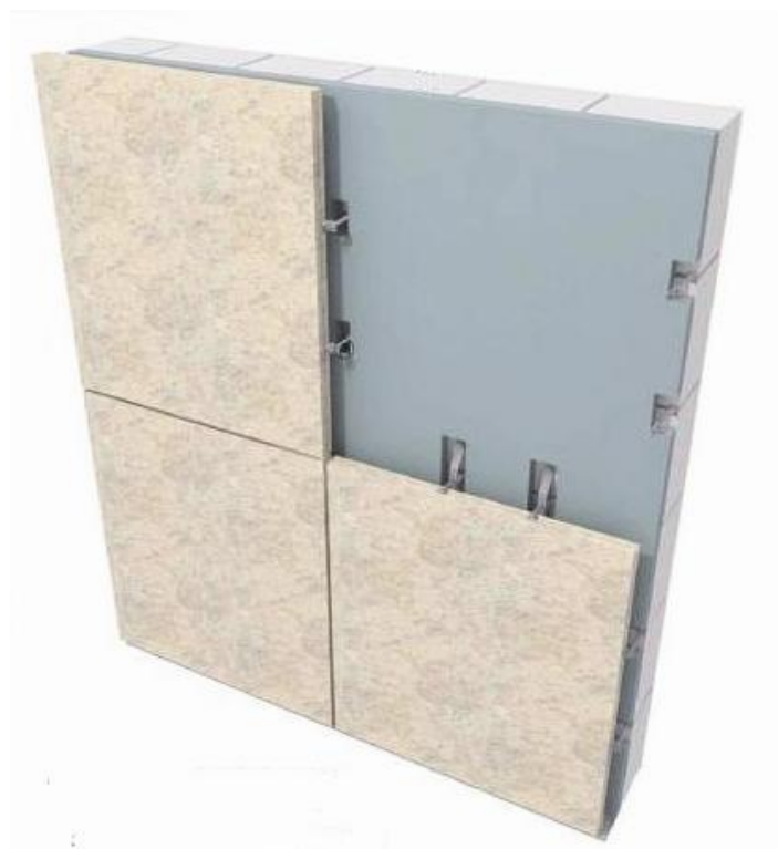
Слика 2 Ношење појединачних плоча од камена анкерима (Watts, 2013)
