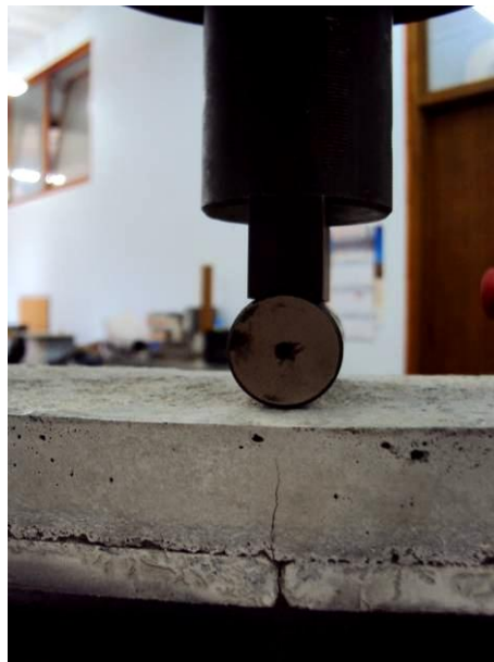
Слика 88 Испитивање чврстоће при савијању композитног фасадног панела: а) испитна композиција, б) испитна опрема, в) лом – појава пукотине на половини распона панела
