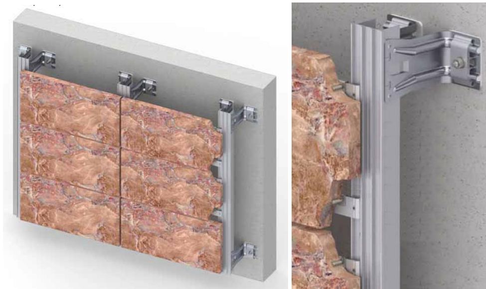
Слика 5 Ношење плоча од камена тракастим носачима који плоче прихватају по полеђини елемента (невидљивим спојем) преко заливених котви (Tehnomarket)
