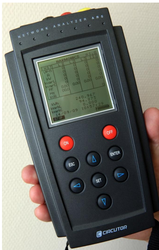
Slika A.4.2.1 Spoljašnji izgled analizatora tipa AR5 proizvođača "CIRCUTOR"
