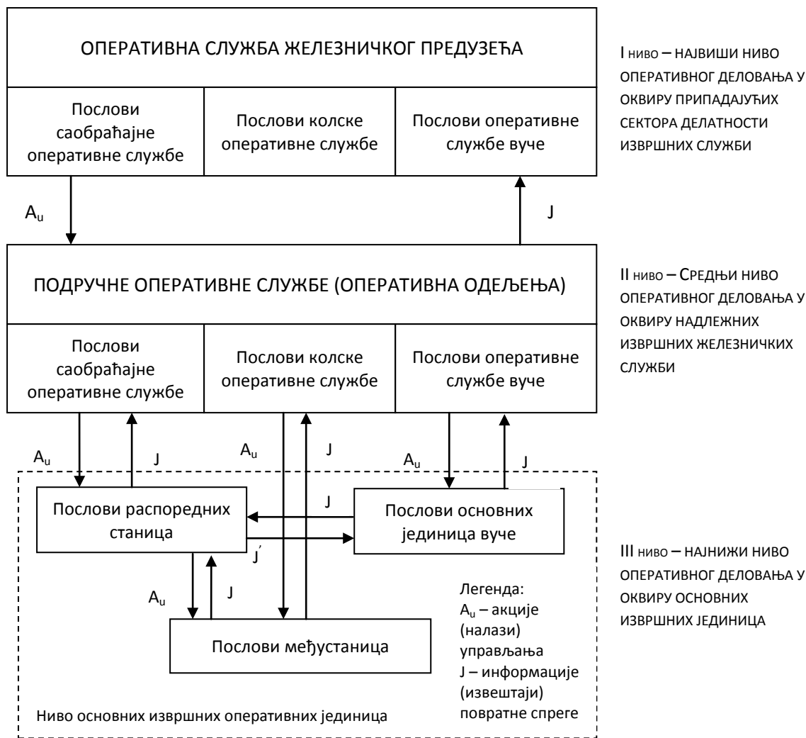
Слика 33. Стратумско-хијерархијски нивои описивања система оперативног управљања са основним токовима информација повратне спреге и акција управљања
