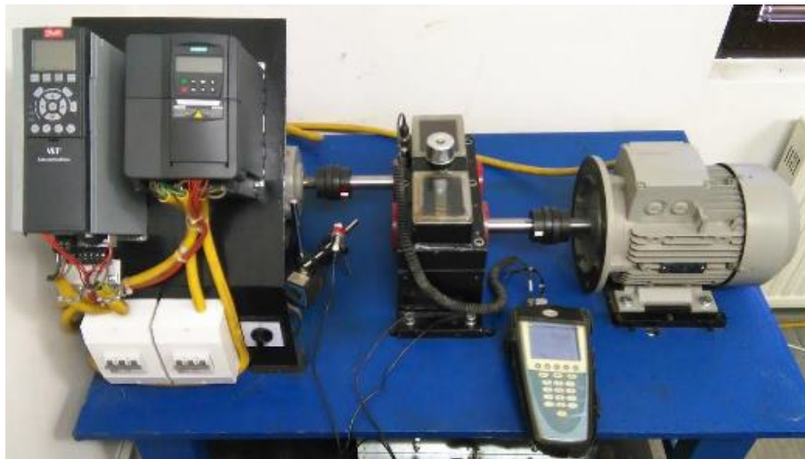
SLIKA 6-1. Probni sto za analizu vibracija rotirajućih mašina sa zupčastim prenosnicima
