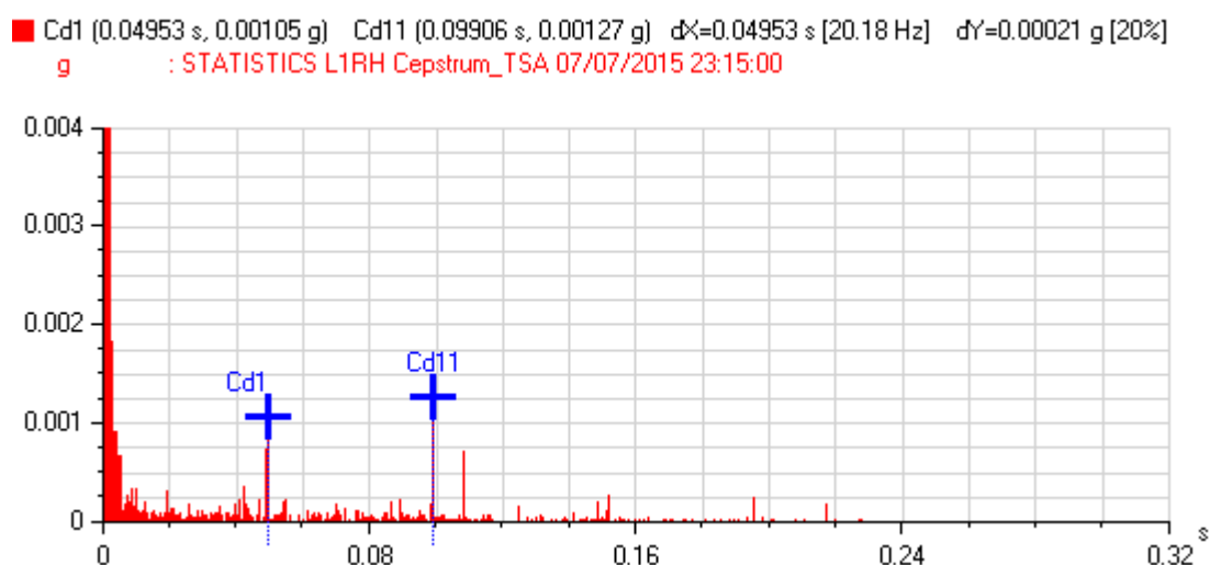
SLIKA 4-6. Cepstrum funkcija snimljena na probnom stolu – slučaj sa pohabanim zupčanicima
