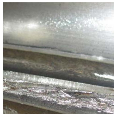
SLIKA 2-10. Lom zuba delimičan – levo, lom kompletnog zuba - desno
