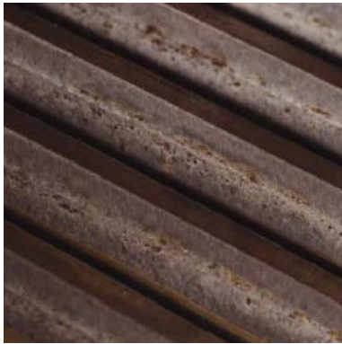
SLIKA 2-8. Početno rupičenje (piting) – levo, uznapredovalo rupičenje - desno
