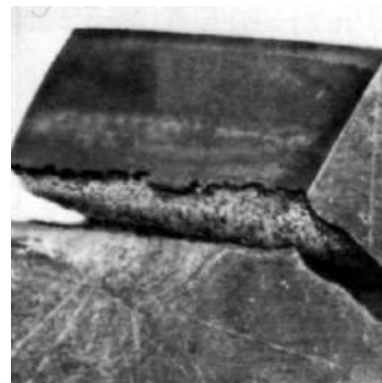
SLIKA 2-9. Početna naprslina- levo, završna naprslina - desno
