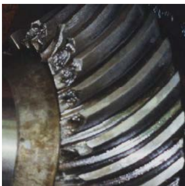
SLIKA 2-10. Lom zuba delimičan – levo, lom kompletnog zuba - desno
