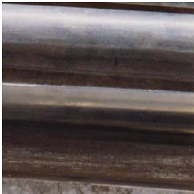
SLIKA 2-5. Nejednako „nošenje“ odnosno jedna strana zupčanika ima veću površinu preklopa
