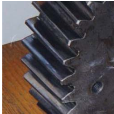
SLIKA 2-4. Velika istrošenost podnožja zubi – levo. Pri vrhu zubi vide se utori po cijeloj površini boka a na desnoj strani bokova došlo je do plastične deformacije – desno
