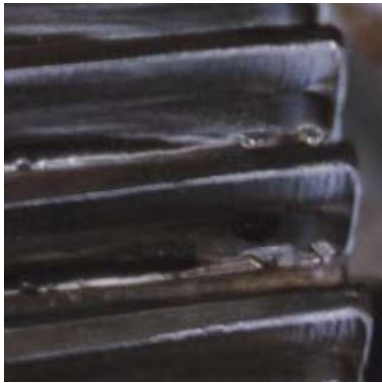
SLIKA 2-4. Velika istrošenost podnožja zubi – levo. Pri vrhu zubi vide se utori po cijeloj površini boka a na desnoj strani bokova došlo je do plastične deformacije – desno
