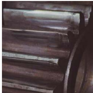
SLIKA 2-5. Nejednako „nošenje“ odnosno jedna strana zupčanika ima veću površinu preklopa
