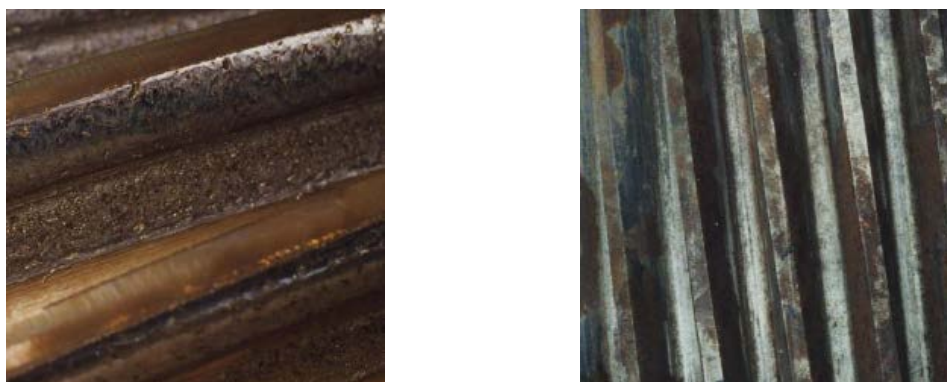
SLIKA 2-7. Eroziija - levo, korozija - desno
