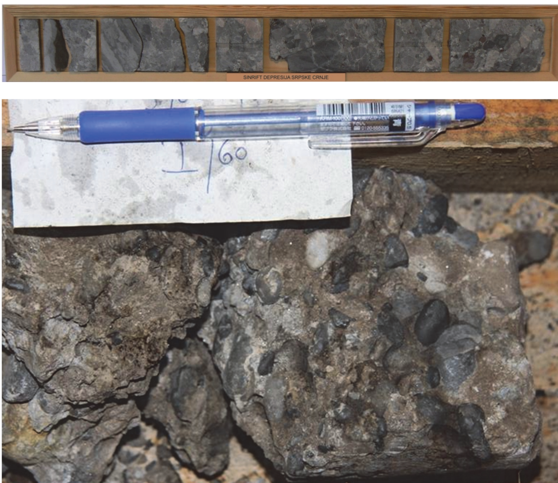
Slika 5.6. Jezgro sinriftnih sedimenata iz depresije Srpske Crnje (gore); donjobadensko jezgro bušotine iz depresije Srpske Crnje (dole).
