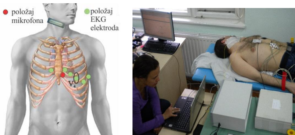
Slika 5.5. Postavljanje EKG elektroda, elektronskog stetoskopa i LPG senzora za snimanje karotidnog impulsa
