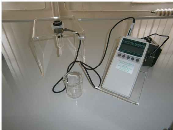
Slika 6. Pletizmometar – aparat za merenje volumena (edema) šape.
