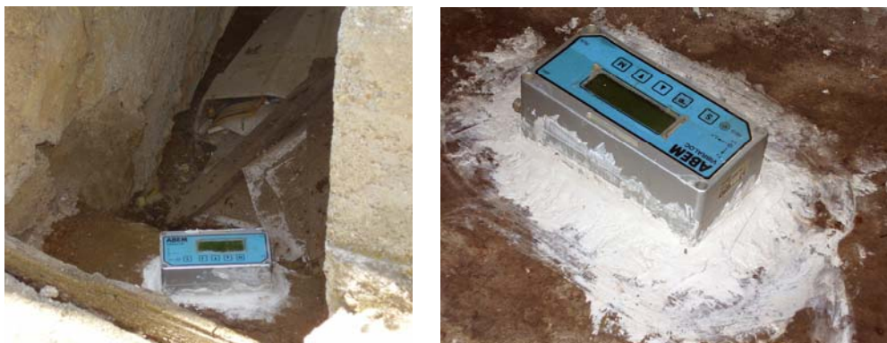
Slika 4-35. Način postavljanja instrumenata za merenje vibracija
