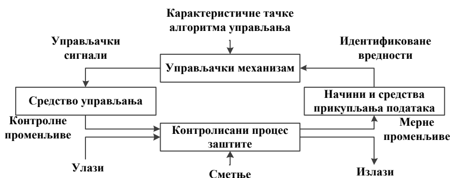
Слика 3.1. Стандардна контролна петља примењена на процес заштите
