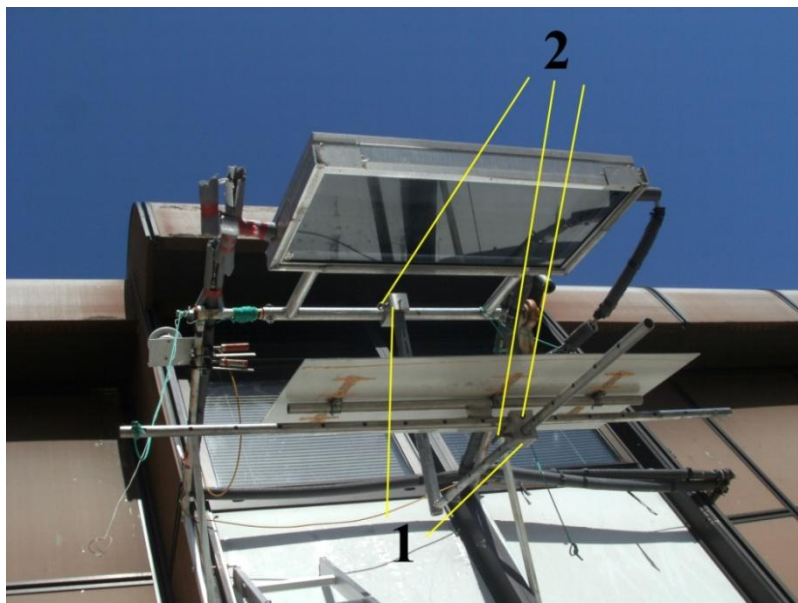
Слика 6.7 Конструкција за померање рефлектора: 1 - алуминијумске коцке и 2 - клинови
