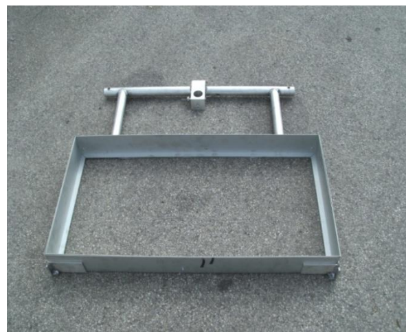
Слика 6.2 Носећа конструкција ПРС-а (лево): 1 - конзолни носач, 2 - осовина са подеоном главом, 3 - носач пријемника и носач пријемника (десно)
