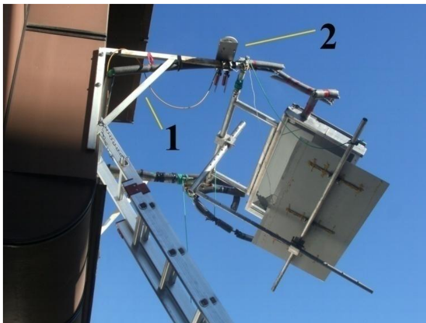
Слика 6.13 Положај пиранометра: 1 - конзолни носач ПРС-а и 2 - пиранометар
