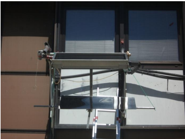
Слика 7.9 Међусобни положај рефлектора и пријемника за 13:00 h (лево) и 14:00 h (десно)
