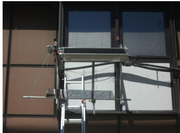
Слика 7.9 Међусобни положај рефлектора и пријемника за 13:00 h (лево) и 14:00 h (десно)
