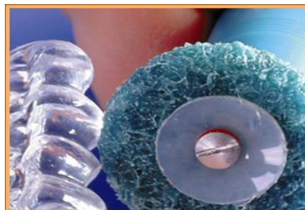
slika 25. Obrada rubova TPK splinta – freza slika 26. Obrada rubova TPK splinta – filc
