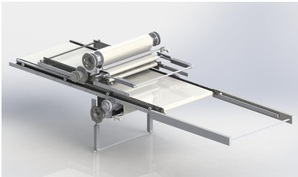
Слика 6.13 Просторни изглед модула за компензацију и модула за слојевање, крајњи положаји хода у назад
