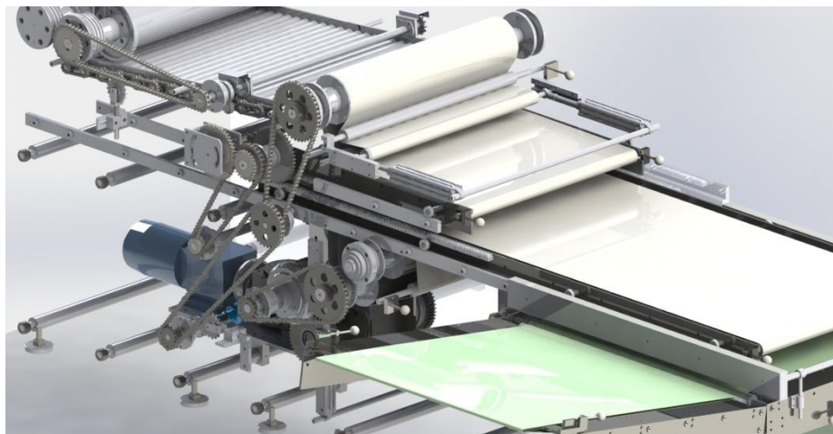
Слика 6.17 Просторни приказ 2 концепта хоризонталног реверзибилног механизма за слојевање интегрисаног у ламинатор MF1200
