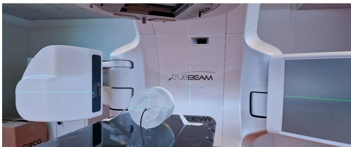
Slika 6.32. Postavka fantoma za proveru CBCT imidžing doze
