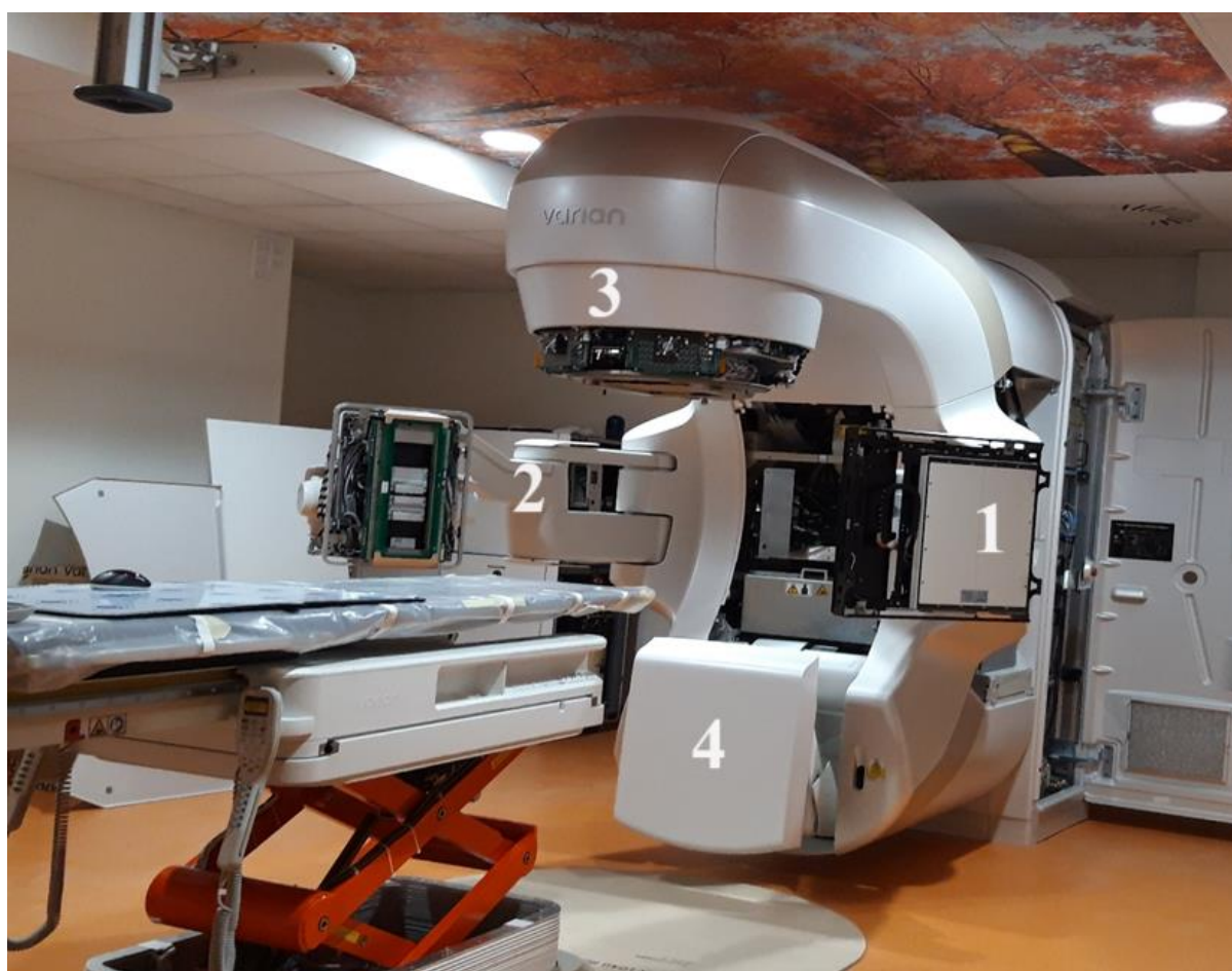
Slika 3.2 Imidžing sistem linearnog akceleratora (1- krak sa kV izvorom, 2- krak sa kV detektorom, 3- MV izvor, 4- MV detektor)
