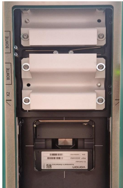
Slika 6.6. Kolimator (dole) kV snopa i bowtie filteri (gore)
