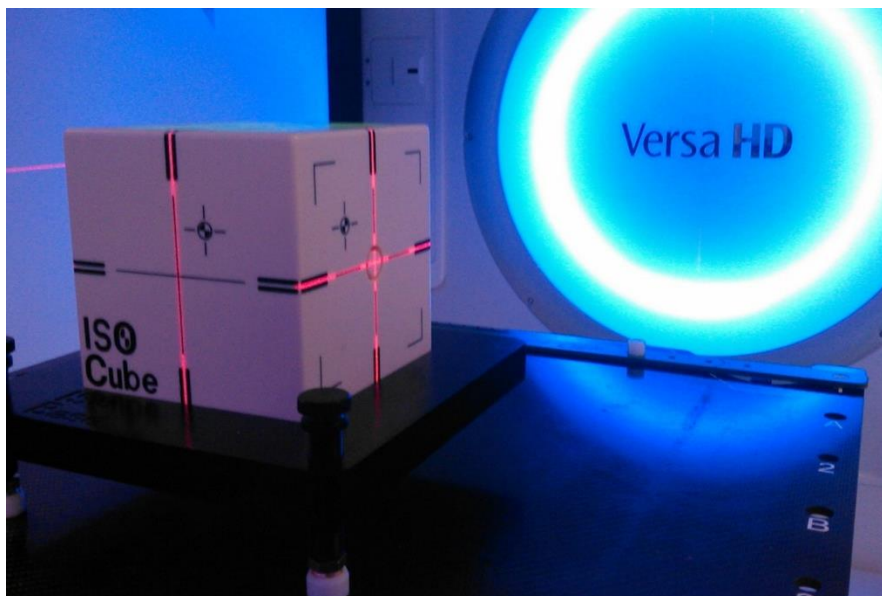
Slika 6.16. Postavka IsoCube fantoma prilikom nedeljnih provera imidžing sistema
