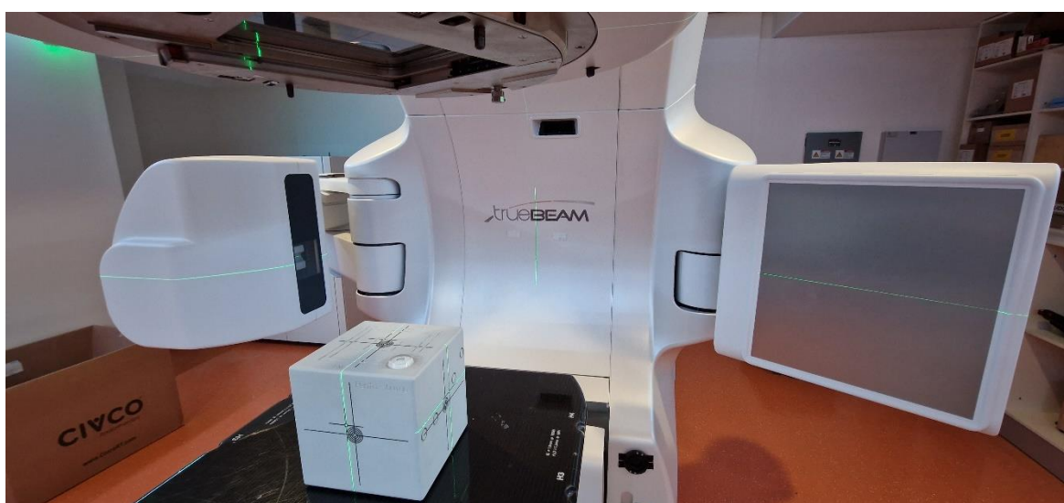
Slika 6.27 Postavka Penta Guide fantoma pri dnevnim proverama kV imidžing sistema
