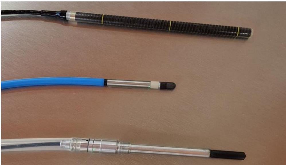
Slika 4.3. Jonizacione komore koje su korišćene prilikom merenja, DCT10-MM (gore), Semiflex (sredina) i Farmer (dole) komora
