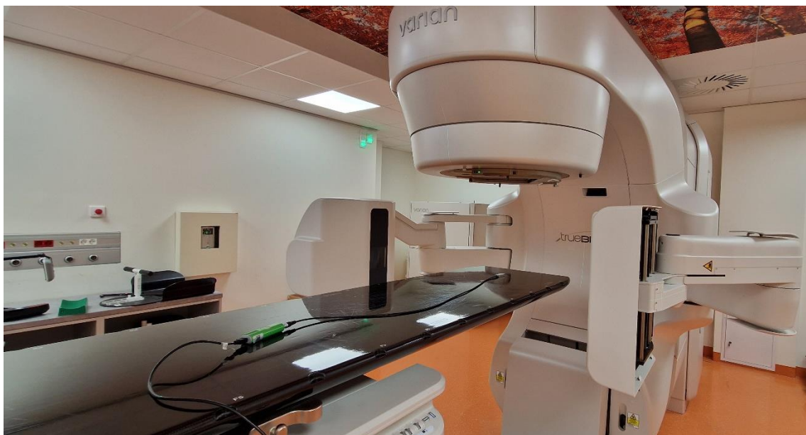
Slika 6.31. Postavka opreme za proveru kvaliteta kV snopa
