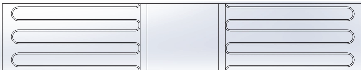
Слика 9.2. Пресјек контролне запремине кориштене за симулацију пада притиска
