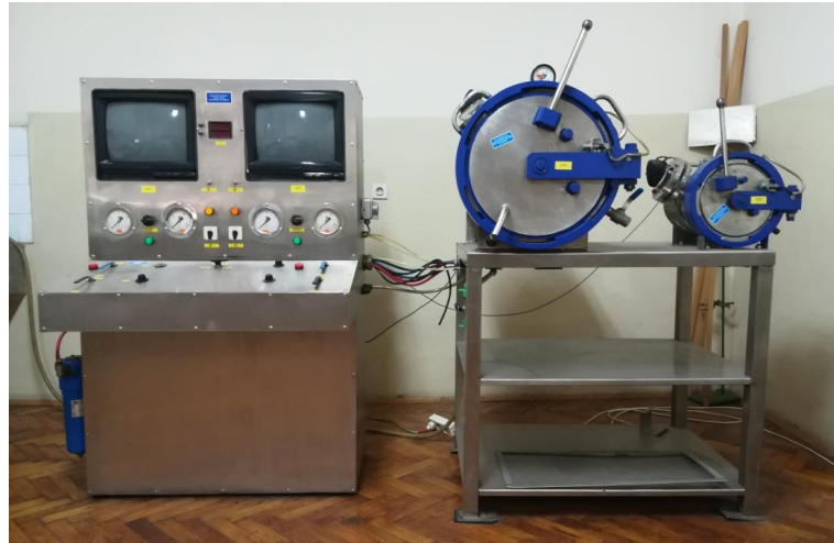
Slika 3.2. Hiperbarična komora za eksperimentalne životinje. Izgled hiperbarične komore za male i velike eksperimentalne životinje u Institutu za medicinsku fiziologiju „Rihard Burijan”.
