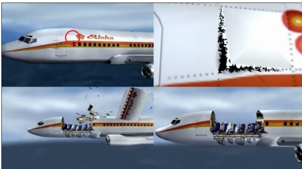
Slika 41. Simulacija havarije aviona Boeing 737 Aloha Airlines Flight 243 [69]
