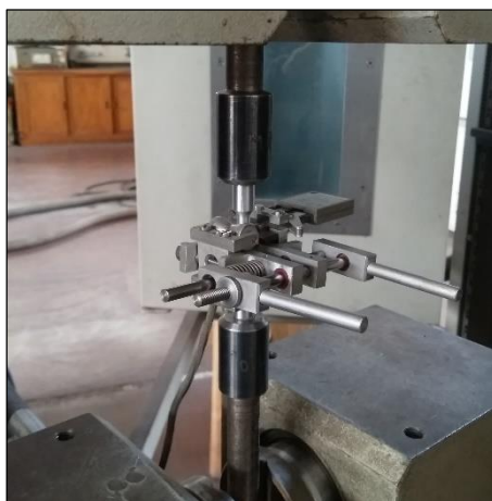
Slika 71. Ispitni uzorak fiksiran između steznih glava kidalice SCHENCK TREBEL Prüfmaschinen 4030 Ratingen RM100, sa ekstenzometrom
