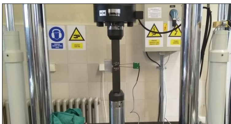
Slika 80. Ispitni uzorak fiksiran između steznih glava servo-hidrauličke kidalice SHIMADZU
