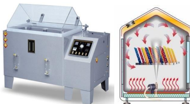
Slika 32. Izgled i princip rada slane komore
