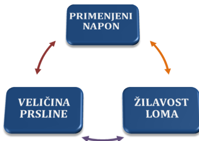
Slika 35. Trougao mehanike loma
