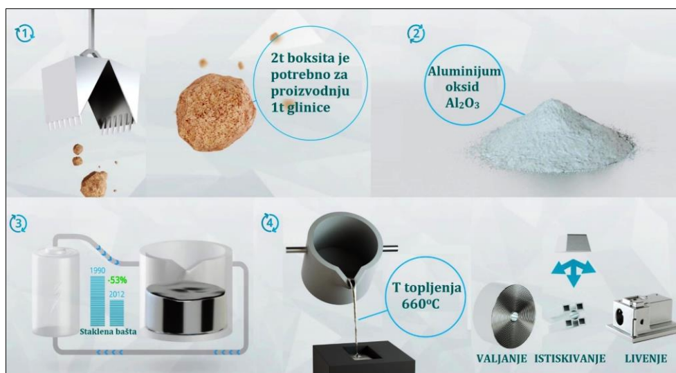
Slika 6. Proces proizvodnje aluminijuma [1]
