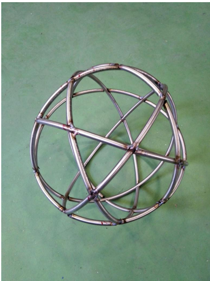
Сл. 28. Конструкција лопте са троугаоним и петоугаоним пољима
