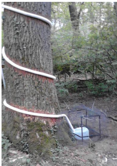
Слика 10. Систем за мерење сливања воде низ кору стабла S-3 (Q.r.) у ограђеном ловишту „Црни луг“, одељење 14, одсек е, постављен у јулу 2015. године.
