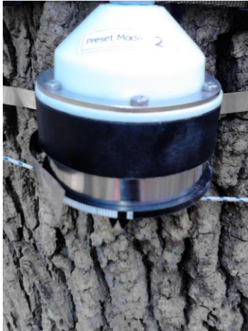
Слика 9. Поставка дендрометра ( Dendrometer Increment Sensor - DR26, EMS Brno ) на храст лужњак (озн. S-2) у одељењу 14, одсек е, у ограђеном ловишту „Црни луг“, 06. априла 2016. године.
