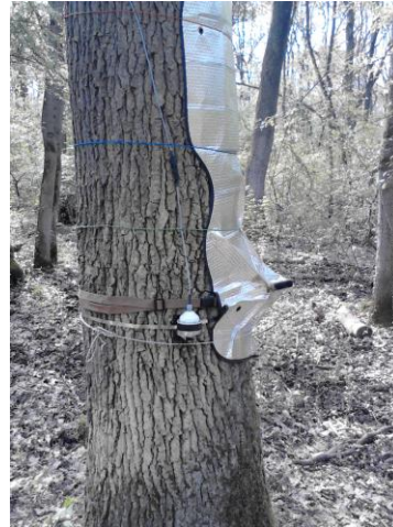
Слика 9. Поставка дендрометра ( Dendrometer Increment Sensor - DR26, EMS Brno ) на храст лужњак (озн. S-2) у одељењу 14, одсек е, у ограђеном ловишту „Црни луг“, 06. априла 2016. године.
