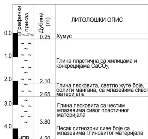
Слика 143. Литолошки профил бушотине P-1/2. Легенда: НПВ – ниво подземне воде.
