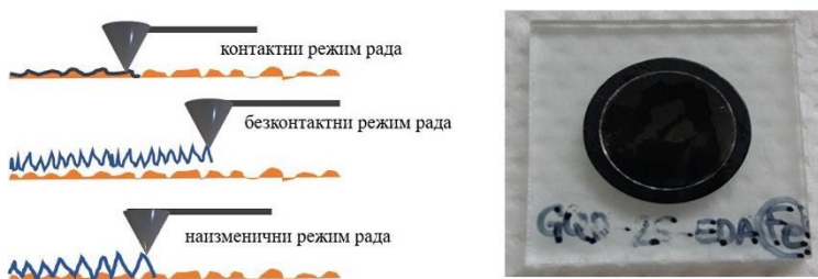
Слика 3.3.1.2. Режији рада микроскопа атомских сила (а) и узорак припремљен за ГКТ за снимање на AFM (б).
