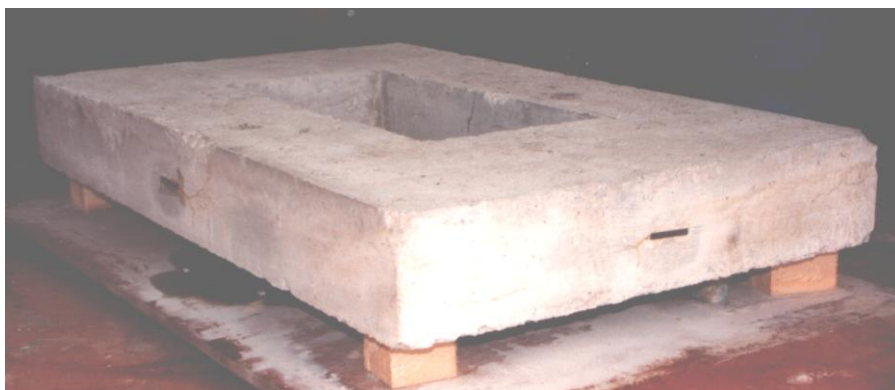
Слика 9.1. Једноделна носећа структура машина израђена од композитног материјала гвожђе-бетон
