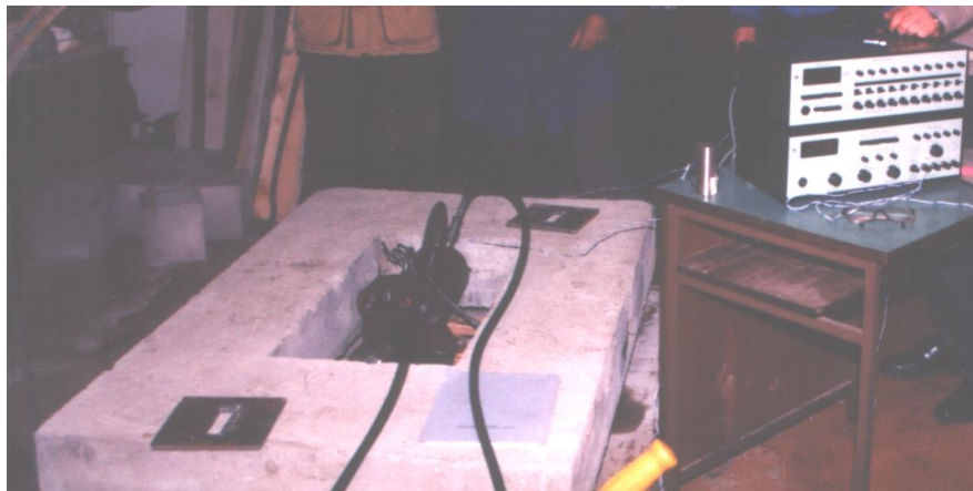
Слика 9.4. Композиција једноделне носеће структуре, мерног уређаја и опреме за оптерећивање
