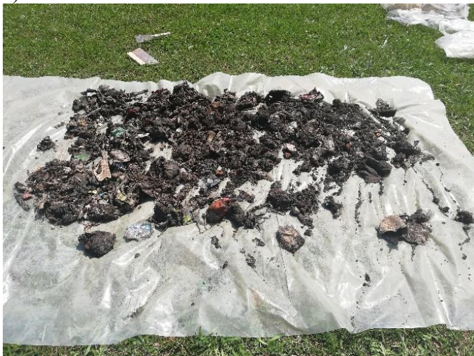
Slika 4.4: Postupak a) sušenja i b) razvrstavanja otpada
