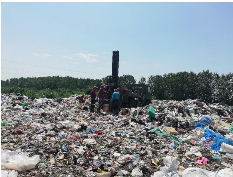
Slika 4.3: Uzimanje uzoraka istražnim bušenjem na deponiji u Plandištu
