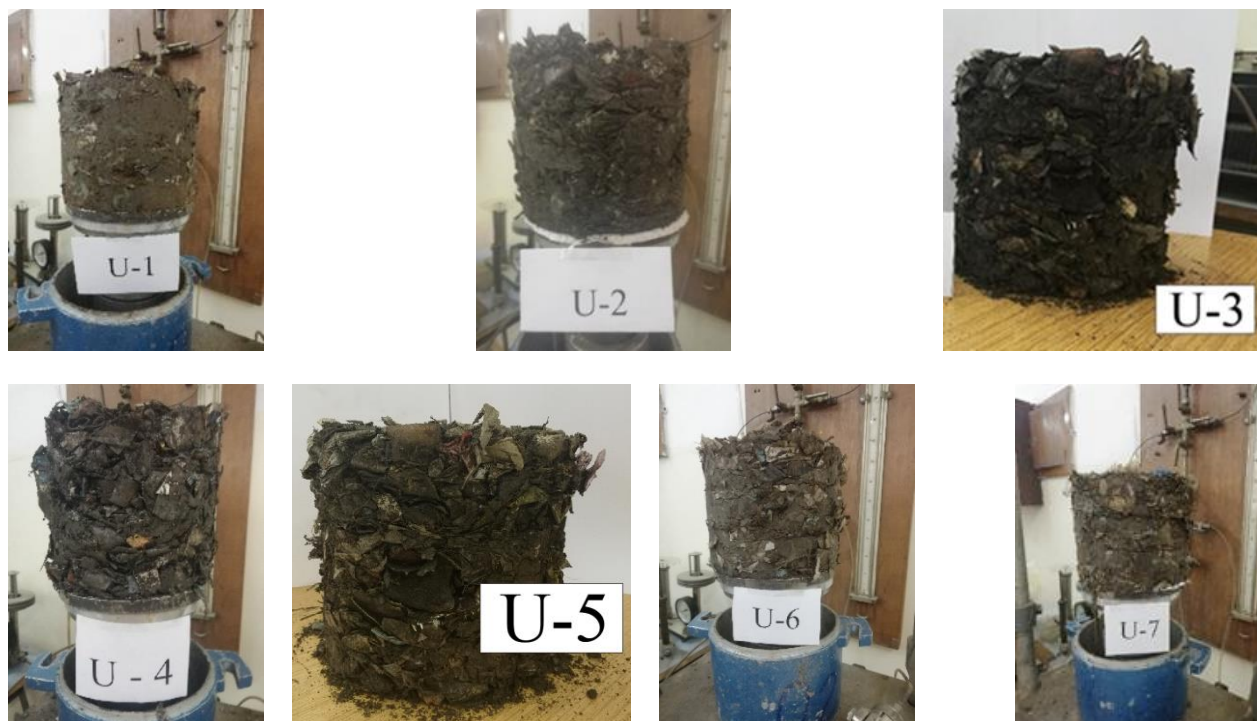
Slika 6.18: Izgled uzoraka komunalnog otpada nakon što su izvađeni iz Proktorovog kalupa
