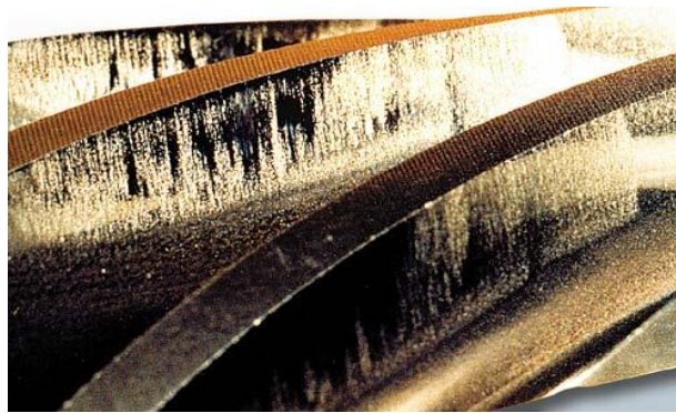
Слика 4.3. Скоринг на боковима зубаца [46]
