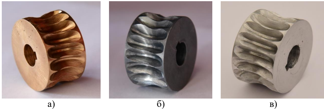
Слика 6.6. Пужни зупчаници израђени од различитих материјала: а) бронза CuSn12, б) цинк-алуминијумска легура ZA12 и в) алуминијумска легура A356
