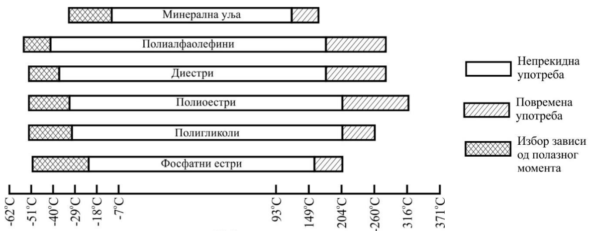
Слика 4.8. Температурска подручја примене течних мазива
