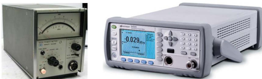
Слика 3.5: Ватметар за термисторске сензоре снаге HP 432A (лево) и Keysight N432A (десно)
