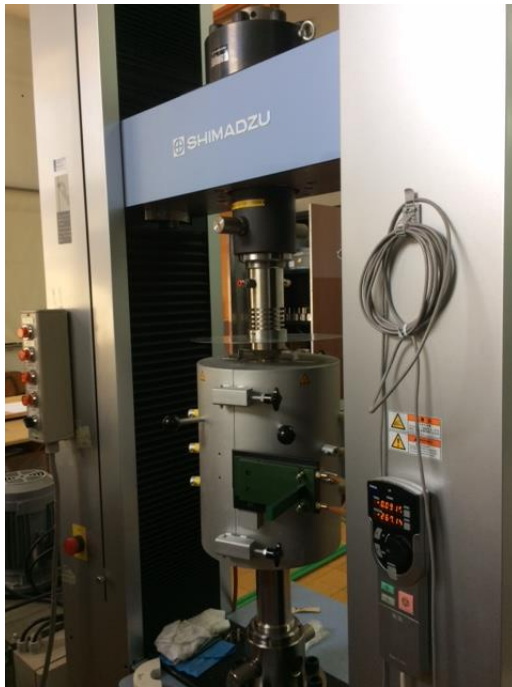
Slika 3.9. Elektromehanička kidalica SHIMADZU sa komorom za ispitivanje na povišenim temperaturama
