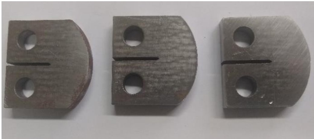
Slika 3.52. Modifikovana C(T) epruveta za ispitivanje brzine rasta zamorne prsline na povišenoj temperaturi
