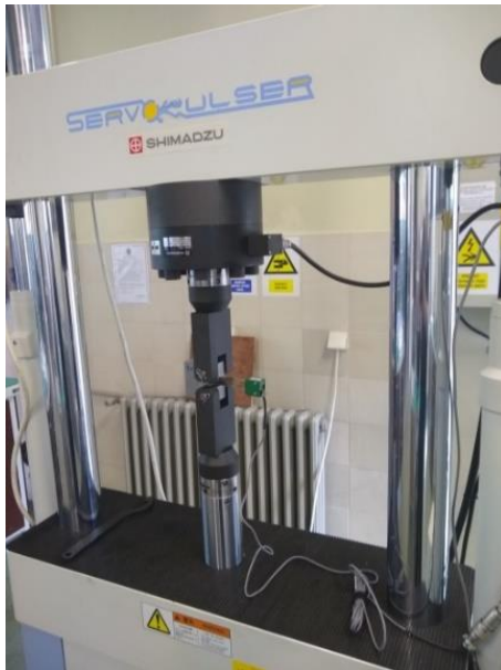
Slika 3.34. Stvaranje prethodne zamorne prsline na servohidrauličkoj kitalici
