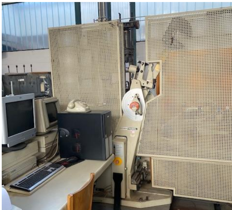
Slika 3.16. Instrumentirano Šarpi klatno 150/300 J
