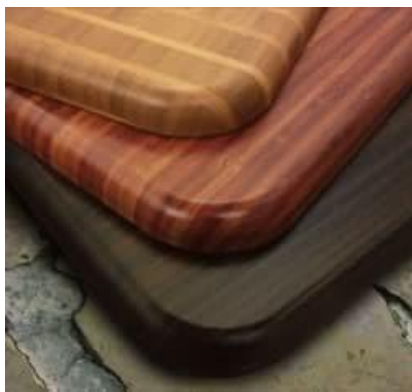
Slika 16. BioSurf – material od sintetizovane soje sa biopolimerom kukuruza
