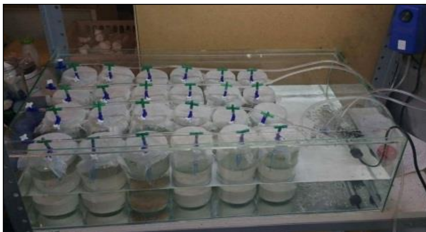
Slika 14. Aparatura za postavku eksperimenta. Stakleni akvarijum sa test-teglama u kojima je sproveden sistem za aeraciju
