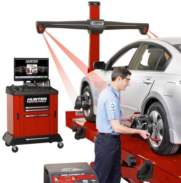
Слика 2.13. Компјутерски систем за регулажу трапа са четири камере високе резолуције
