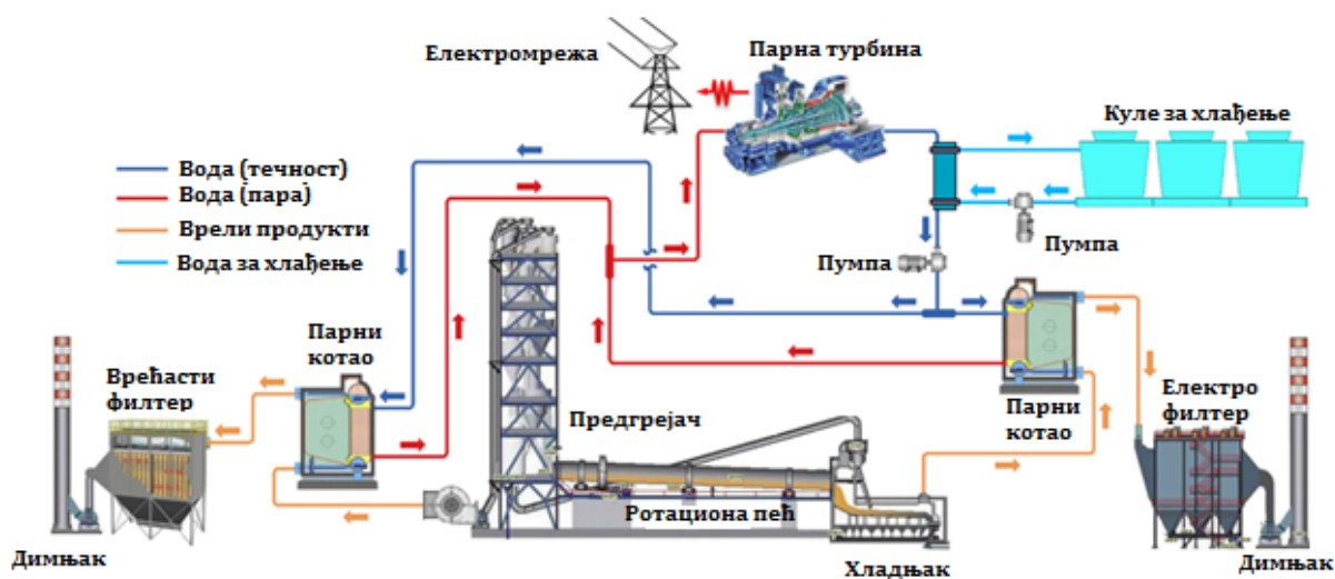
Слика 36. Шематски приказ модерног постројења за калцинацију
