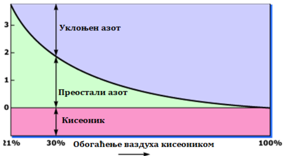
Слика 44. Утицај обогаћења ваздуха кисеоником на концентрацију азота
