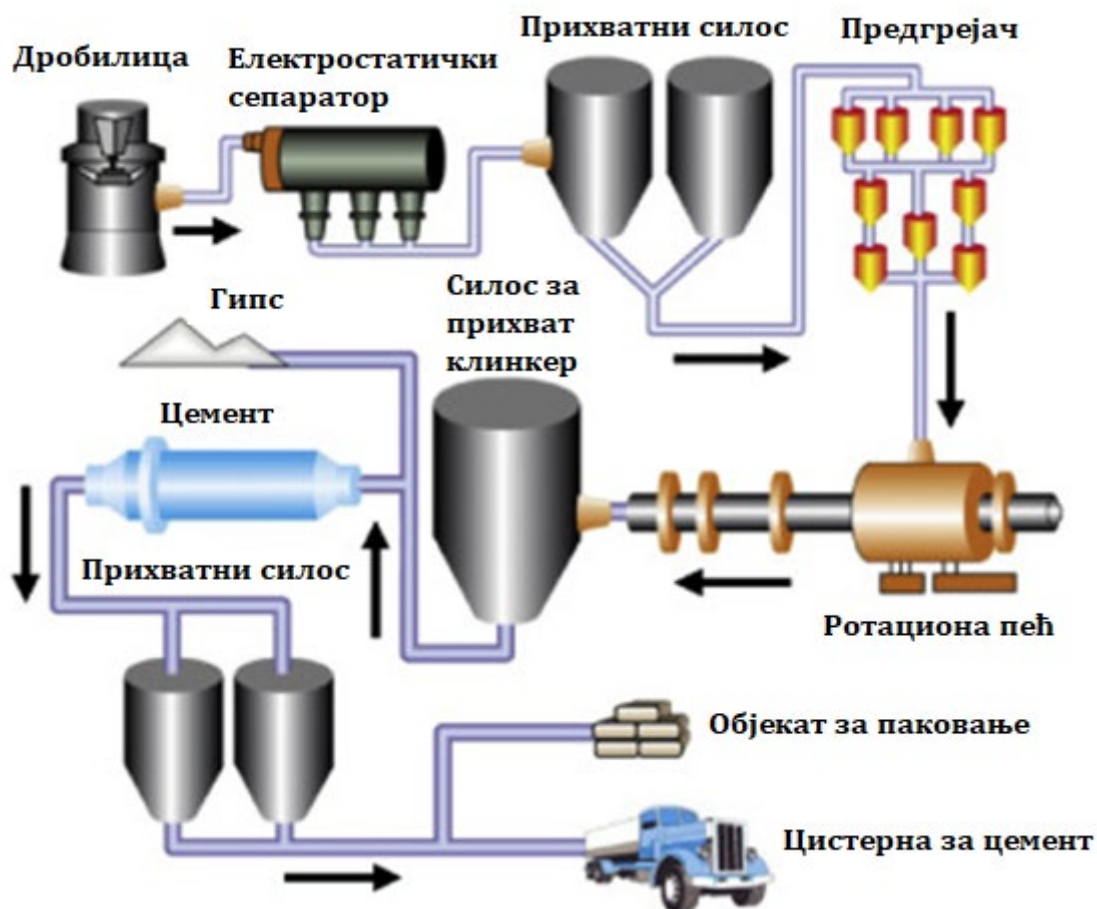
Слика 8. Шематски приказ типичног постројења за производњу цемента
