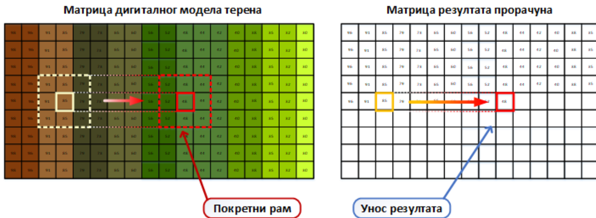
Слика 3-7: Принцип покретног рама
