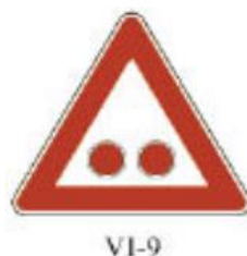
Slika 2.5. Saobraćajni znak: „Semafor za regulisanje prelaza puta preko željezničke pruge u istom nivou” (VI-9)
