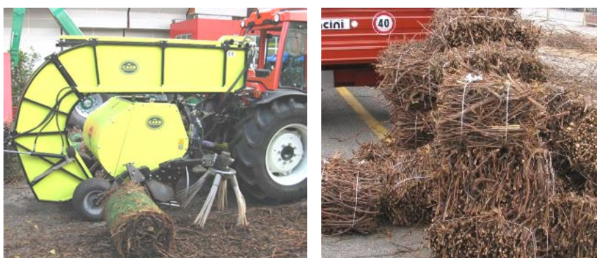
Slika 6. Valjkaste i četvrtaste bale ostataka rezidbe vinograda i voćnjaka (Martinov et al., 2011)
