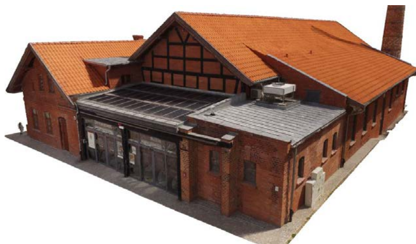
Sl. 3.15 – 3D model objekta generisan na osnovu fotografija prikupljenih dronom (Banaszek et al., 2017)
