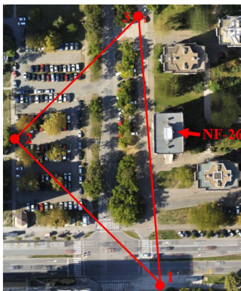
Sl. 5.3 – Skica snimanja orijentacionih tačaka na fasadama predmetne zgrade totalnom stanicom
