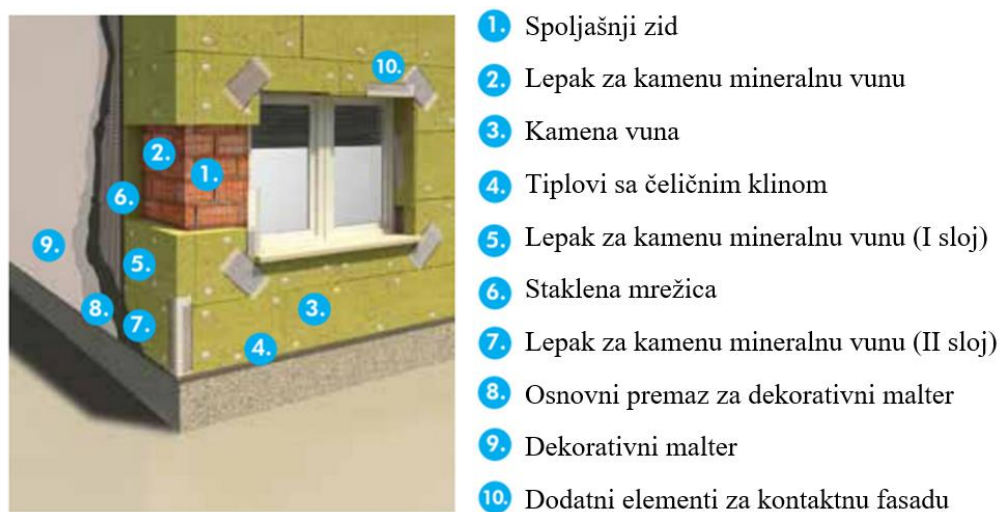
Sl. 5.86 – Kontaktna fasada: komponente sistema sa kamenom mineralnom vunom (Knauf Insulation)
