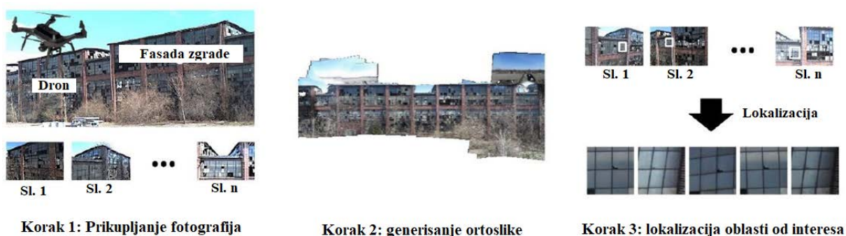
Sl. 3.16 - Osnovne faze postupka vizuelnog pregleda fasada zgrada zasnovanog na primeni fotografija zabeleženih bespilotnom letelicom, koji su razvili Choi et al. (2018)
