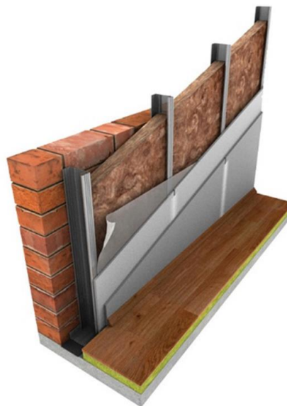
Sl. 5.89 – Predloženo rešenje za postavljanje toplotne izolacije sa unutrašnje strane spoljnih zidova (Knauf Insulation, 2020)
