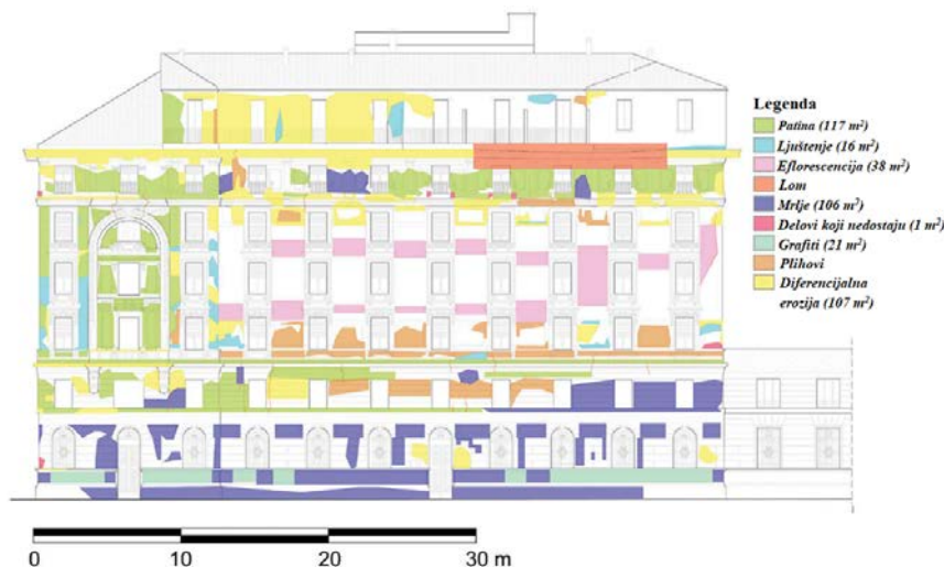
Sl. 3.18 - Mapa deterioracije fasade (Russo et al., 2019)
