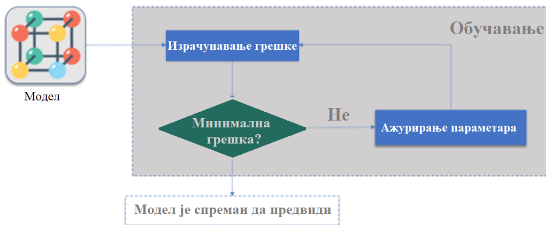
Слика 2.4.9: Принцип рада Backpropagation алгоритма за обучавање (Извор: [82])
