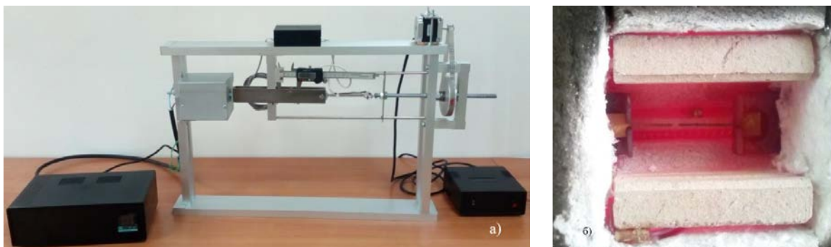
Слика 5.8 Уређај са модулом за испитивање материјала на повишеним температурама; а) комплетна апаратура; б) детаљ из коморе након кидања епрувете
