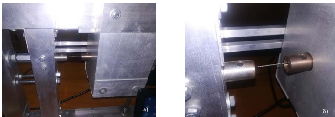
Слика 5.22 Модул са комором: а) кретање коморе ради позиционирања и стезања епрувете пре почетка испитивања, б) епрувета у систему прихвата и стезања чаурама са вијком
