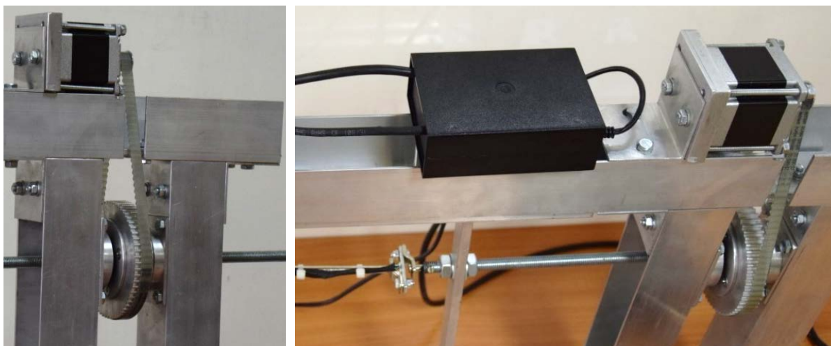
Слика 5.12 Оптимална решења улежиштења и естетске функције: а) конусни ваљкасти лежаји лево и десно од ременице; б) дизајн и позиција кутије за Arduino
