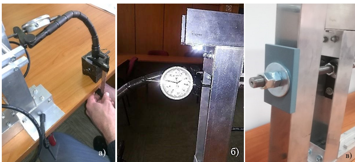
Слика 5.16 Попустљивост подсклопа везе рама носеће конструкције уређаја и леве чељусти кидалице: а) постављање компаратера, б) Мерење померања непокретне чељусти уређаја током испитивања; в) навојна веза између непокретне чељусти и рама конструкције
