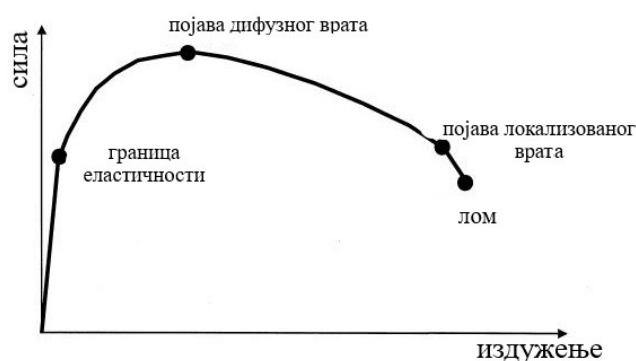
Слика 3.19 Изглед дијаграма сила - издужење [Z.L. Zhang, 1999]
