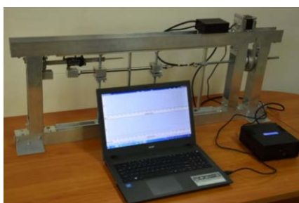
Слика 5.32 Приказ алтернатива, четири варијанте мале лабораторијске кидалице
