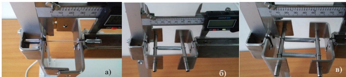
Слика 5.5 Позиционирање узорака за испитивање: а) позиција пробног узорка, б) позиција једне опруге, в) позиција две паралелно везане опруге
