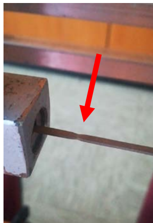
Слика 6.12 Формирање врата на епрувети током испитивања
