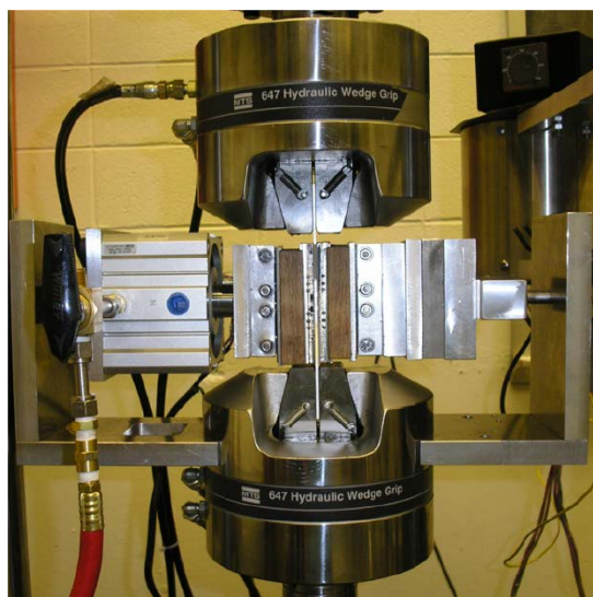
Слика 2.40 Уређај за испитивање материјала затезањем/притискањем равних узорака на повишеној температури [K. Piao, 2012]
