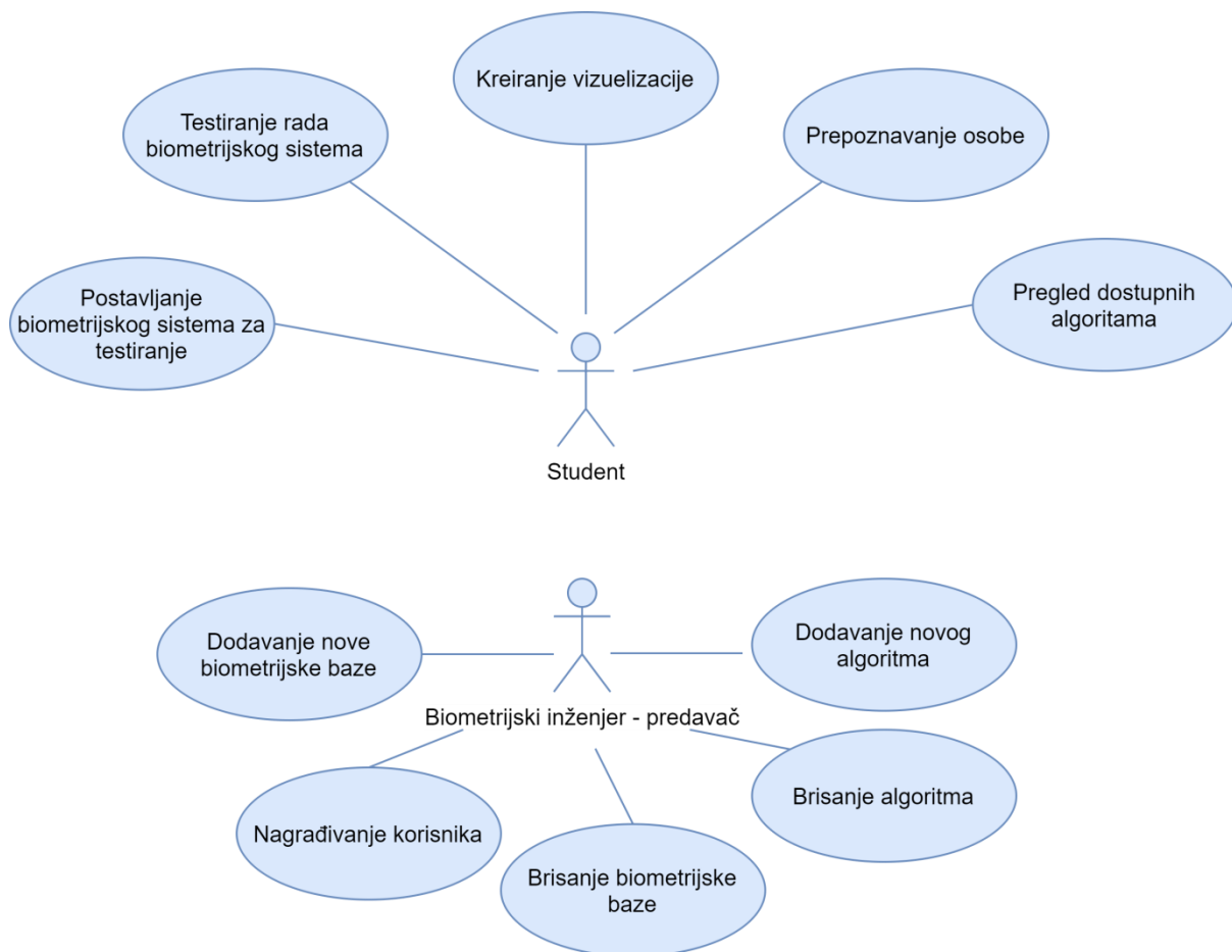
Slika 44 – Dijagram slučajeva korišćenja za biometrijski alat u procesu obrazovanja
