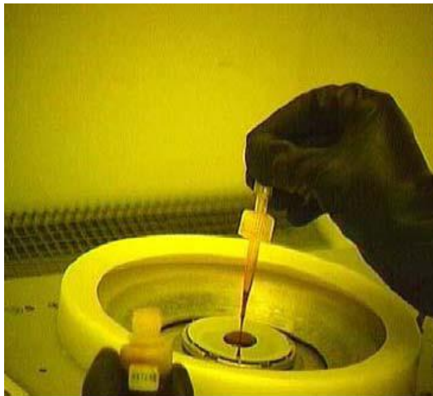
Slika 2.3. Nanošenje fotopolimerizujuće smole, rezista, na spineru i priprema pločice za fotolitografski postupak
