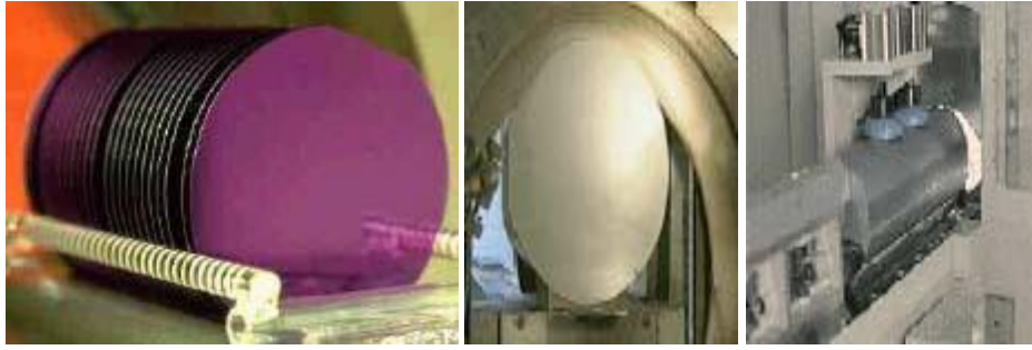
Slika 2.4. Sušenje pločica silicijuma u peći, postavljenih u teflonske ladice
