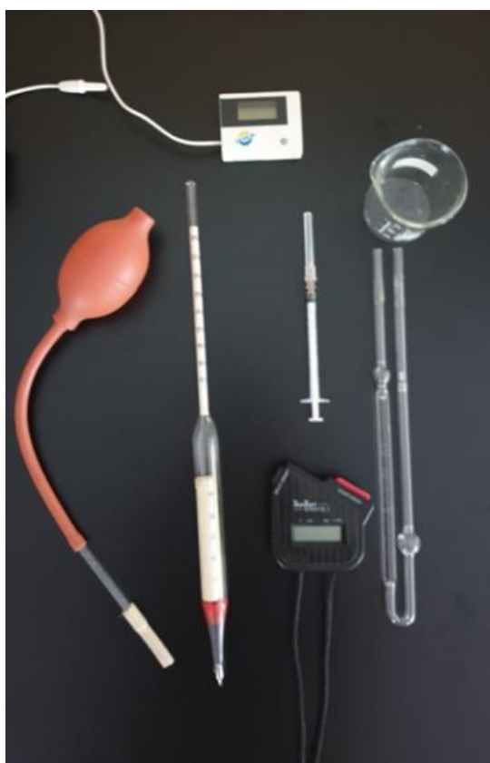
Slika 19. Pribor i aparatura za određivanje viskoznosti tečnosti: pumpica, areometar, špric sa iglom, štoperica (hronometar), digitalni termometar sa sondom i Osvaldov viskozimetar.
