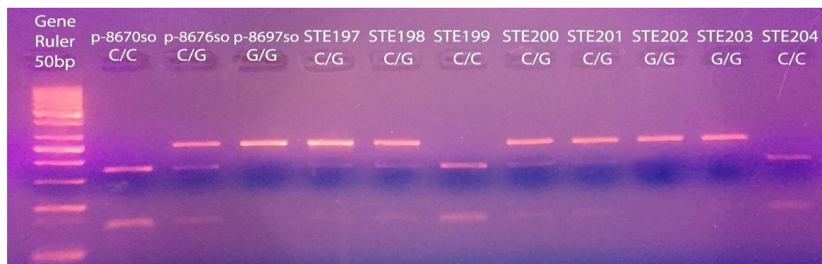
Slika 4.8. Rezultati genotipizacije genetičke varijante rs2477686 metodom RFLP. Homozigot C/C detektovan je prisustvom dve trake veličina 73bp i 173bp, heterozigot C/G prisustvom tri trake veličina 73bp, 173bp i 246bp i homozigot G/G prisustvom jedne trake veličine 246bp. (GeneRuler 50bp – standard za dužinu; oznakama p-8670so, p-8676so i p-8697so obeleženi su kontrolni uzorci restrikcione digestije; oznakama STE 197-204 obeleženi su uzorci sterilnih muškaraca).
