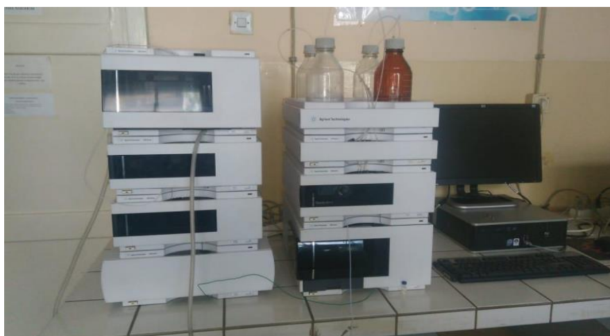
Slika 26. Tečni hromatograf visokih performansi (HPLC) korišćen za analizu ispitivanih uzoraka
