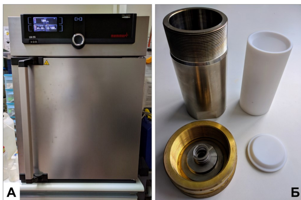
Слика 4.2. (А) Пећница Memert UN55 и (Б) Изглед тефлонске кивете и реактора за солвотермалну синтезу у полиолима.
