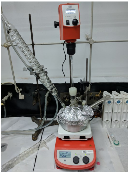
Слика 4.3. Приказ апаратуре за полиол синтезу на атмосферском притиску у лабораторијском трогрлом балону уз константно механичко мешање.
