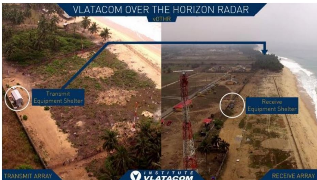
Slika 2.3. Rx i Tx antenski niz položaja HFSW radara [36]
