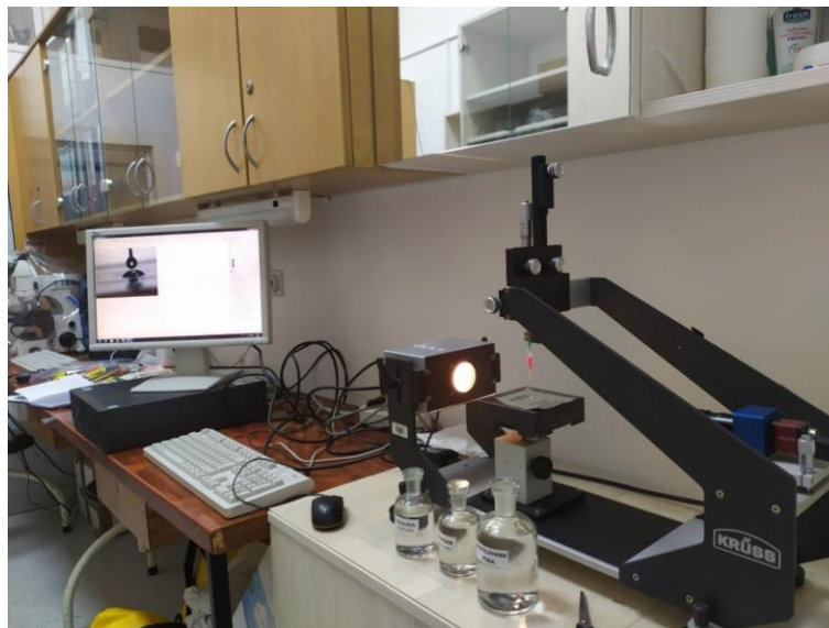
Slika 45: Uređaj Krüss DSA 25 za merenje kontaktnog ugla sa pripadajućim softverom
