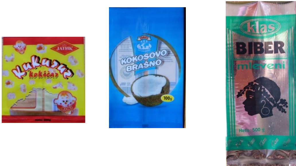
Slika 26: Ispitivani materijali: a) BOPP 40 \mu\text{m} , b) PET/PE, c) PETmet/PE
