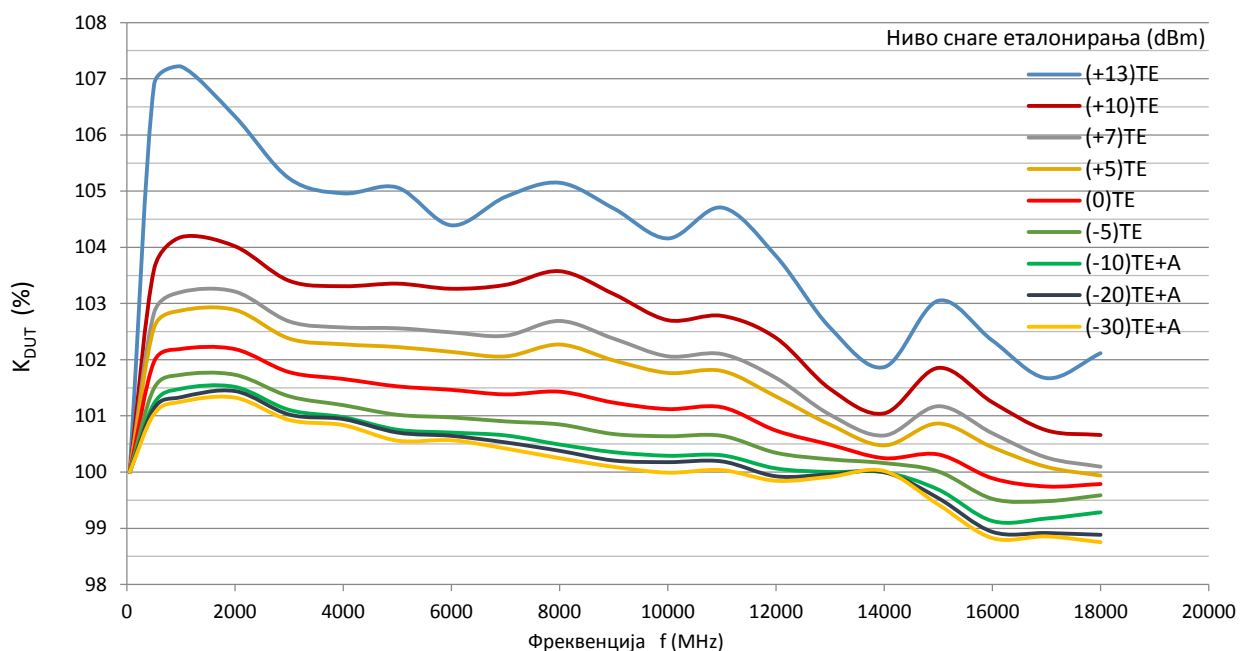
Слика 9.1: Фактори еталонирања ( K_{DUT} ) за диодни сензор Agilent E4413A мерени унапређеном методом за различите нивое снаге.
