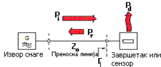
Слика 2.5: Ток снаге између извора и потрошача (сензора).
