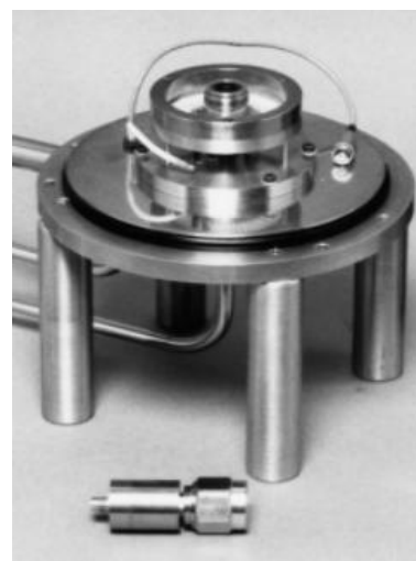
Слика 5.2: а) Коаксијални микрокалориметар и референтни еталон-термисторски сензор, б) блок шема микрокалориметра (NIST).
