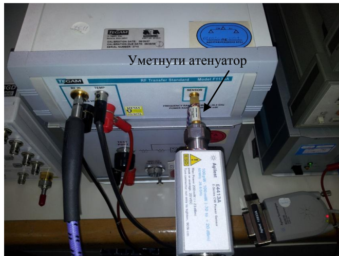
Слика 7.8: Еталонирање сензора Agilent E4413A са уметнутим непознатим атенуатором.
